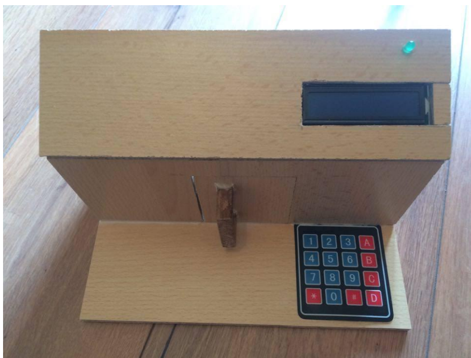
Slika 19. Slika gotove makete Arduino elektroničke brave
