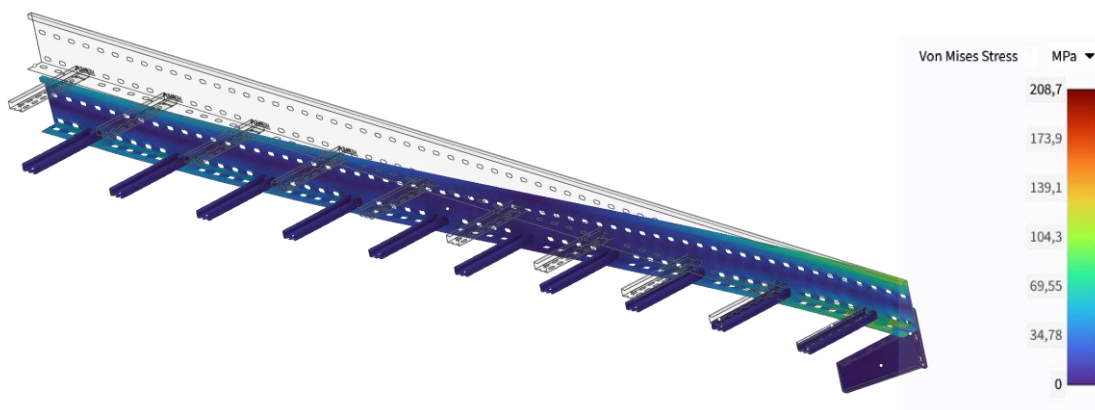
Slika 4.33 Ekvivalentna von Misesova naprezanja na optimiranom modelu
