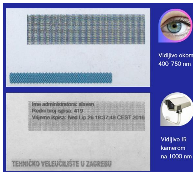
Slika 4.16 Povezivanje putem IRD zaštitnih kodova
