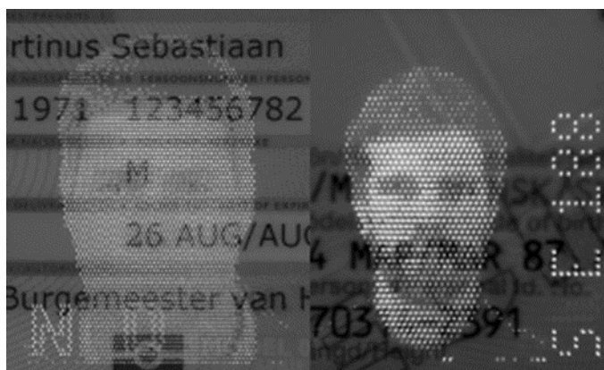
Slika 4.20 Primjena tehnike laserske perforacije
