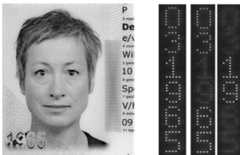
Slika 4.21 Prikaz primjene laserske perforacije s promjenjivim efektom
