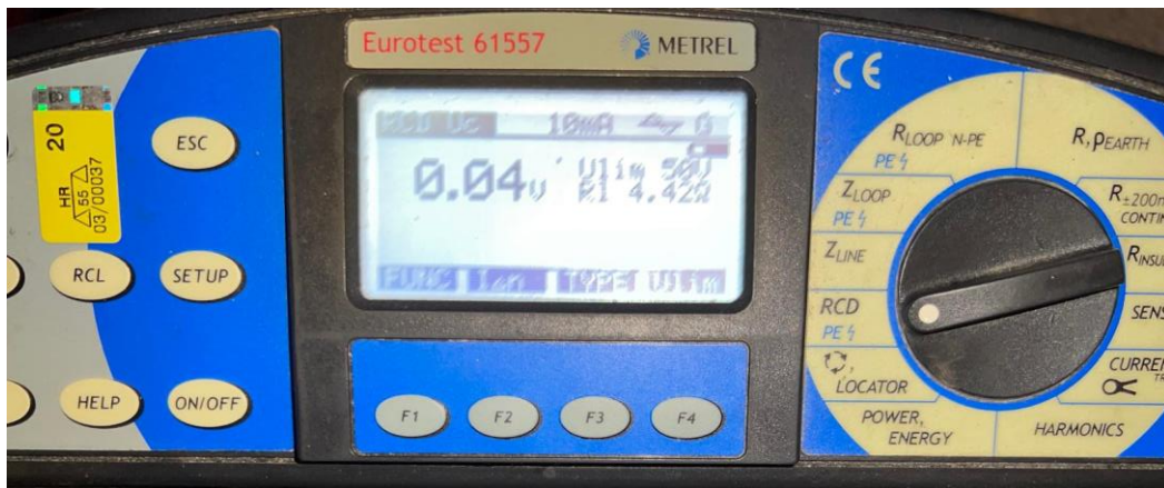
Slika 5.7. Rezultati dobiveni ispitivanjem otpora uzemljenja
