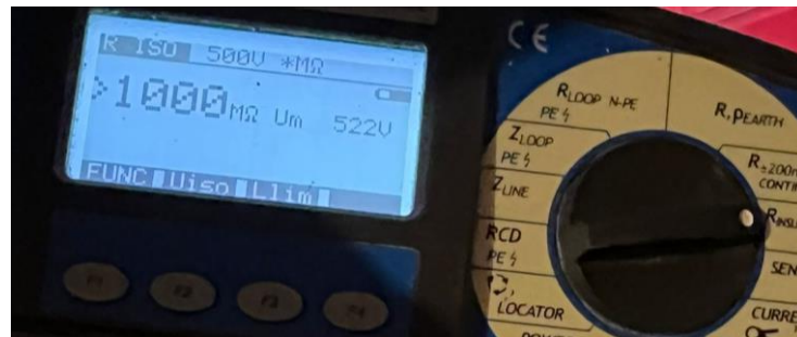
Slika 5.5. Rezultati dobiveni ispitivanjem električnog izolacijskog otpora vodiča
