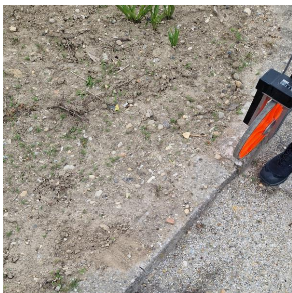
Slika 4. Mjerenje udaljenosti mjernim kotačem
