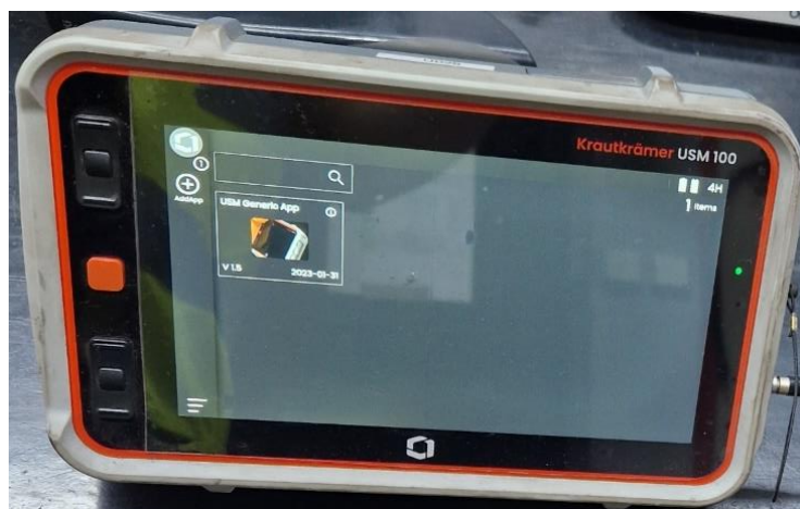
Slika 5.14 Ultrazvučni uređaj Krautkramer USM 100 [28]
