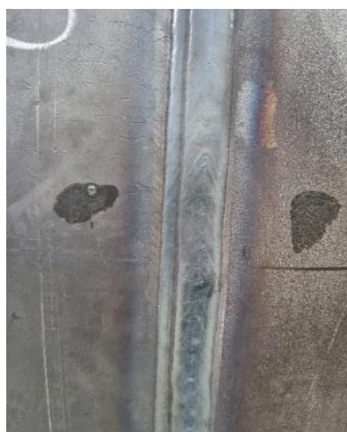
Slika 5.27 Nanošenje kontaktnog sredstva na ispitnu površinu [28]
