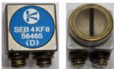
Slika 4.5 Dvostruka sonda SEB4KF8 [28]
