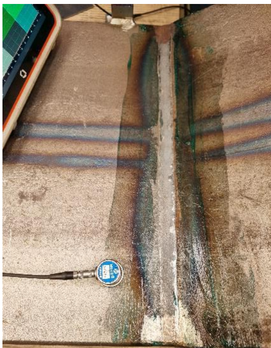
Slika 5.45 Ispitivanje ravnom sondom zbog mogućih dvoslojnosti [28]
