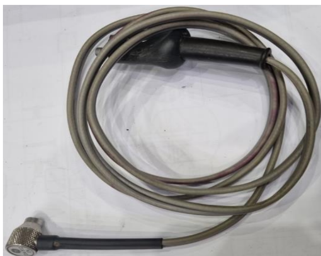
Slika 5.24 Ultrazvučna sonda DA 512 EN [28]
