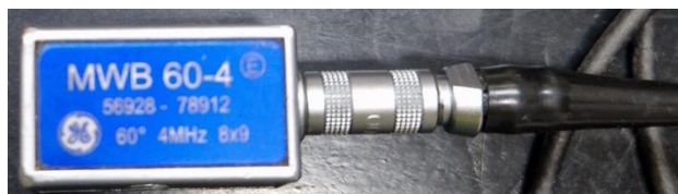
Slika 5.15 Kutna sonda MWB 60-4 [28]
