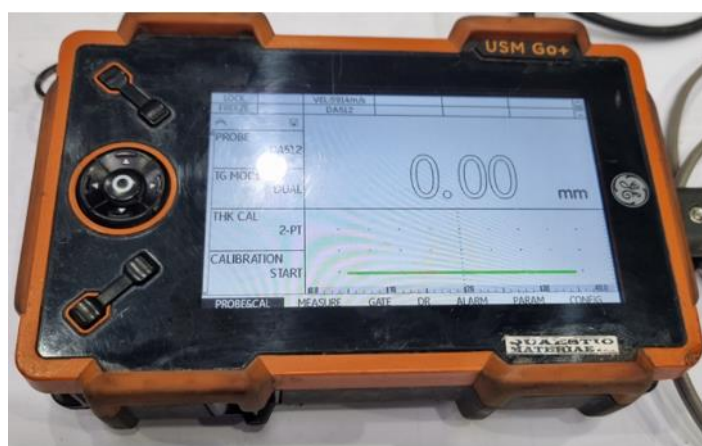
Slika 5.23 Ultrazvučni uređaj USM Go+ [28]
