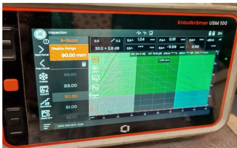
Slika 5.51 A-prikaz dobiven metodom odjeka [28]
