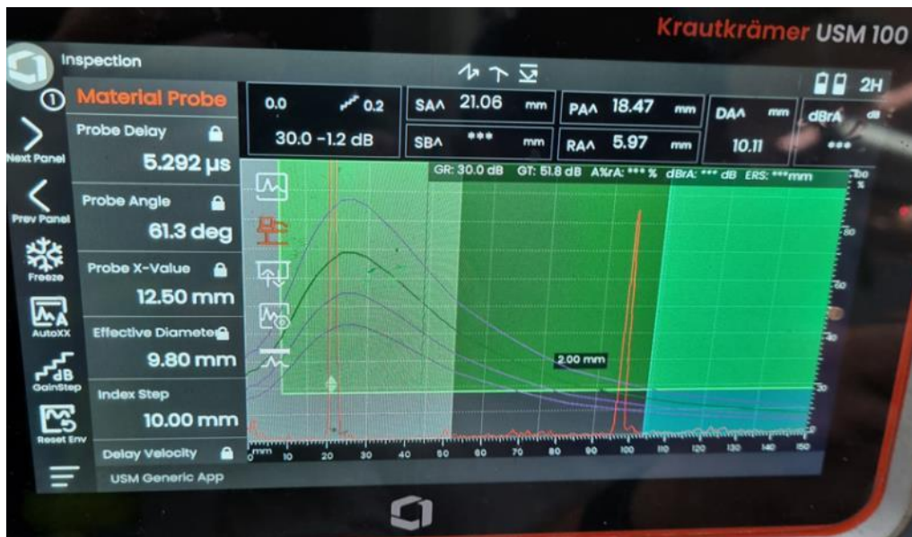
Slika 5.41 Amplituda signala kod kalibracije kutne sonde [28]
