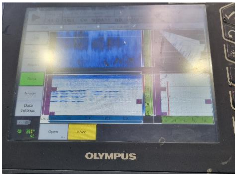
Slika 5.48 Višestruki prikaz rezultata višepretvorničkom metodom [28]
