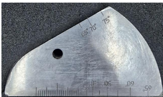
Slika 5.18 Kalibracijski blok V2 [28]
