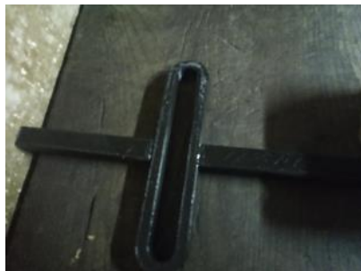
Slika 5.8.:Jaram s vodilicama
