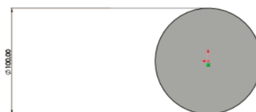
Slika 4.2.: Krug nacrtan alatom Kružnica i kotiran
