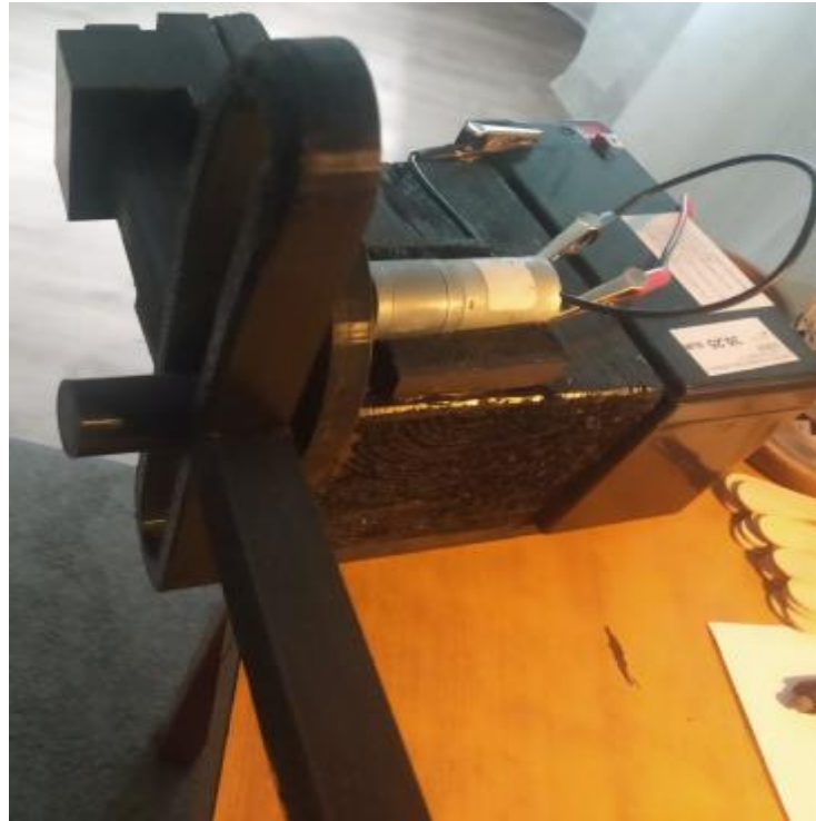
Slika 5.12.:Mehanizam škotskog jarma
