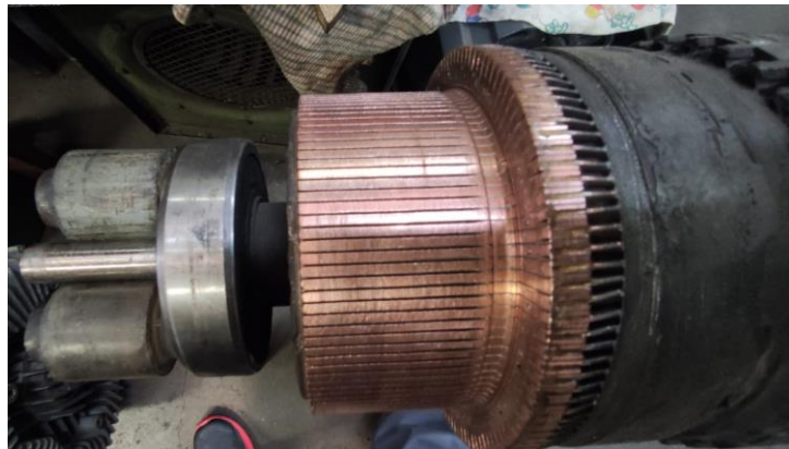
Slika 14. Očišćeni kolektor i namoti rotora (slikano u Elki 22. 4. 2024.)
