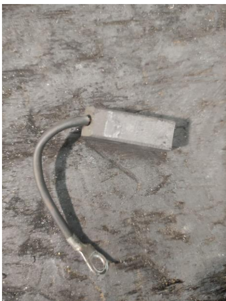
Slika 29. Nova četkica (slikano u Elki 28. 6. 2024.)
