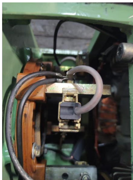
Slika 30. Četkica u utoru (slikano u Elki 28. 6. 2024.)
