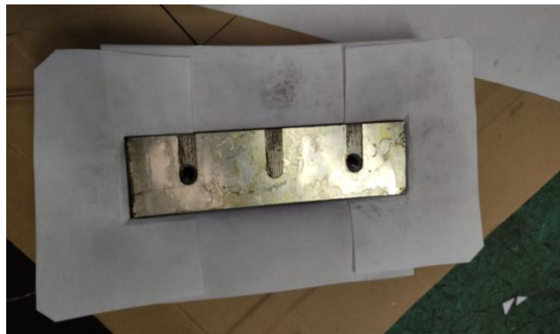
Slika 24. Namot i jezgra izolirani izolacijskim papirom (slikano u Elki 26. 6. 2024.)
