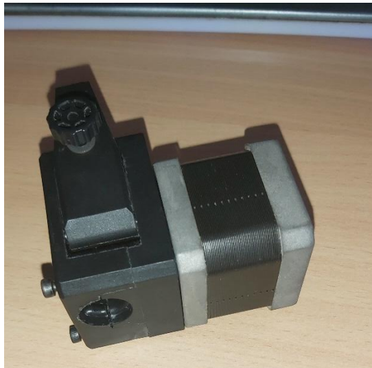
Slika 3.8 Bontech BMG ekstruder sa stepper motorom
