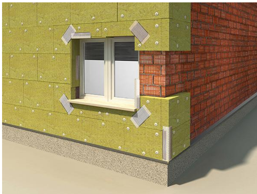
Slika 4.3.8. Učvršćivanje ploča od kamene mineralne vune
