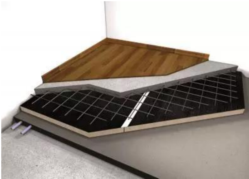
Slika 8.3.4. Plivajući pod s toplinsko zvučnom izolacijom
