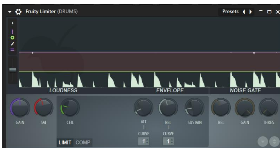
Slika 31 Postavke limitatora za perkusije unutar FL studio limitera
