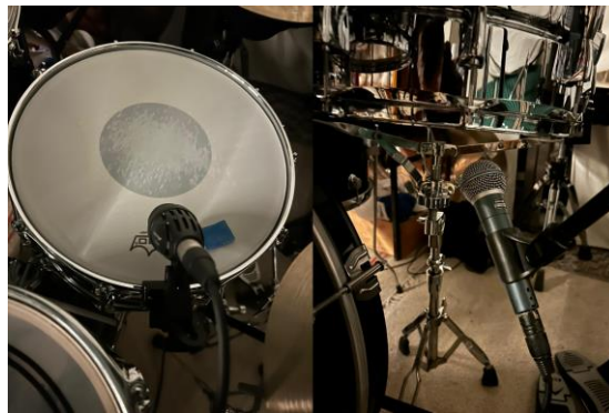
Slika 25 Postavljanje mikrofona za snare
