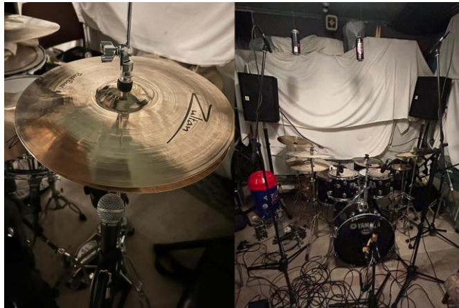
Slika 27 Postavljanje mikrofona za Hi-Hat i overhead
