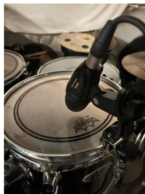
Slika 26 Postavljanje mikrofona za tomove
