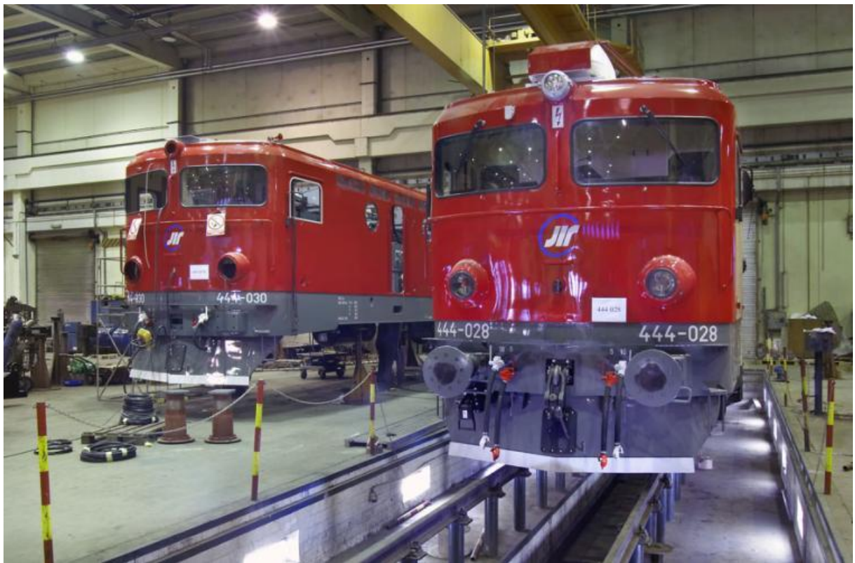
Slika 4. Modernizacija električne lokomotive serije 444
