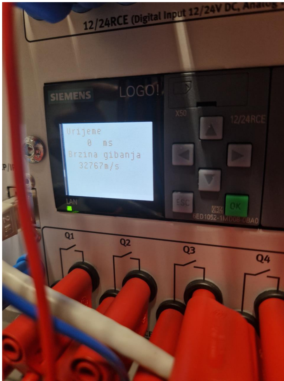
Slika 30 Računski dio programa /7 – ispis vrijednosti na LOGO! ekranu u laboratoriju
