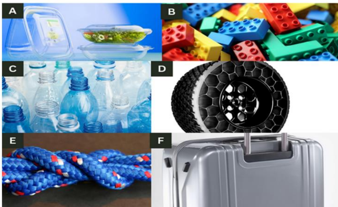
Slika 7: Različite vrste polimernih materijala dobivenih od (A) polimljične kiseline (PLA) - spremnici za hranu; (B) akrilonitril butadien stiren (ABS) – Lego kocke; (C) polietilen tereftalat (PET) – boce s vodom; (D) termoplastični elastomeri (TPE) – bezračne gume; (E) poliamid (PA) ili najlon-uže; (F) polikarbonat (PC) – kofer na kotrljanje
