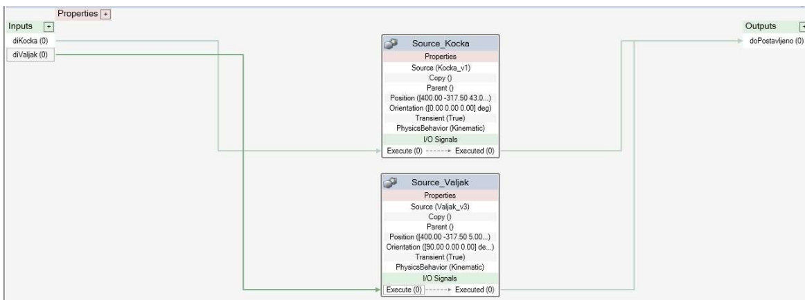
Slika 4.19. – Spojene unutarnje komponente „SC_Postolja“ pametne komponente
