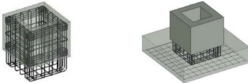
Slika 3.1 Izvedba temeljne čašice [3]
