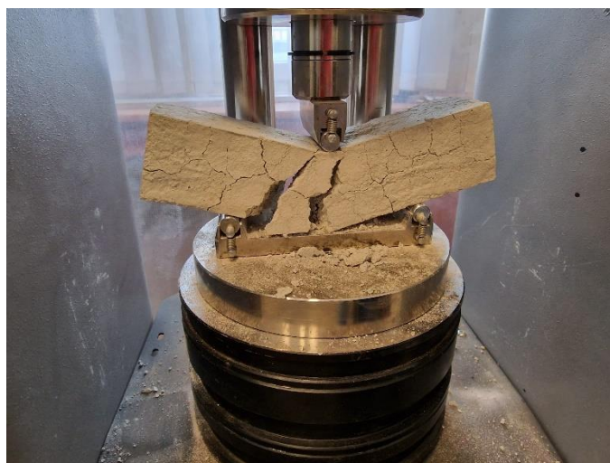
Slika 4.14 Slom prizmice sa pepelom biomase prilikom određivanja vlačne čvrstoće
