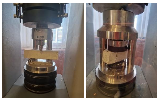
Slika 4.11 Određivanje vlačne i tlačne čvrstoće
