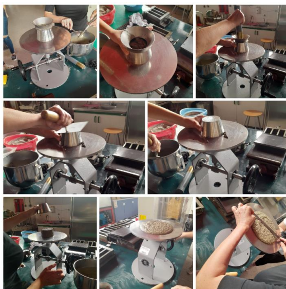
Slika 4.9 Određivanje konzistencije morta na stoliću za potresanje
