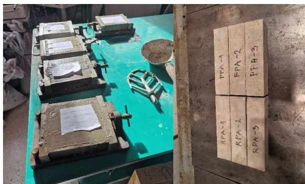
Slika 4.2 Mješavine ugrađene i izvađene iz kalupa
