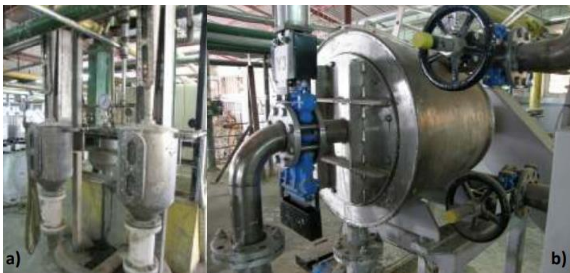
Slika 8. Centrifugalni pročištač (a), fibersorter (b)
