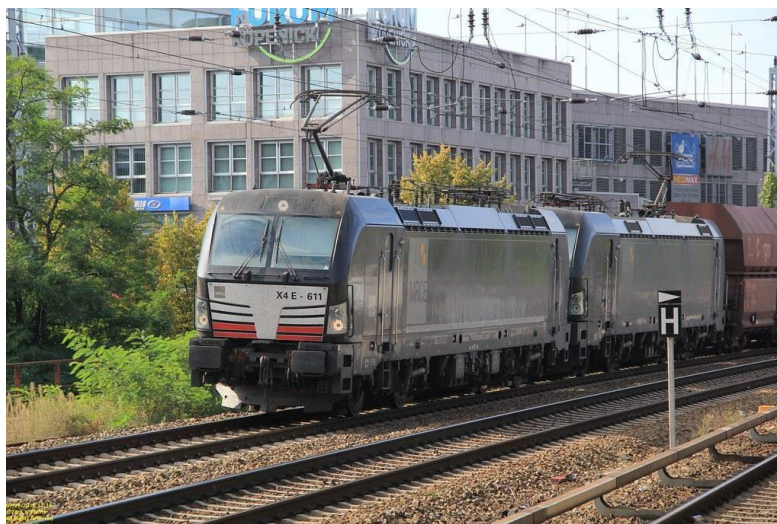
Slika 8. Električna lokomotiva Vectron 6193
