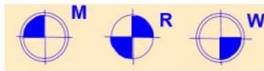
Slika 15. Referentne i nul-točke CNC stroja [12]
