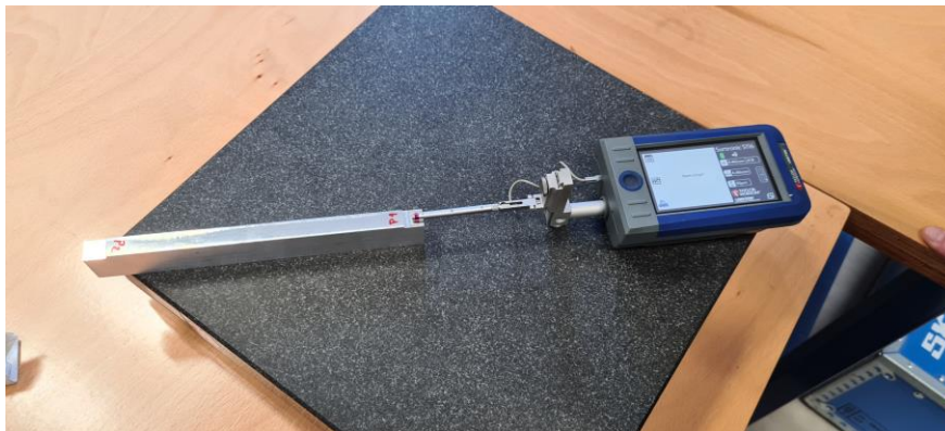
Slika 30. Uređaj za mjerenje hrapavosti površine [18]
