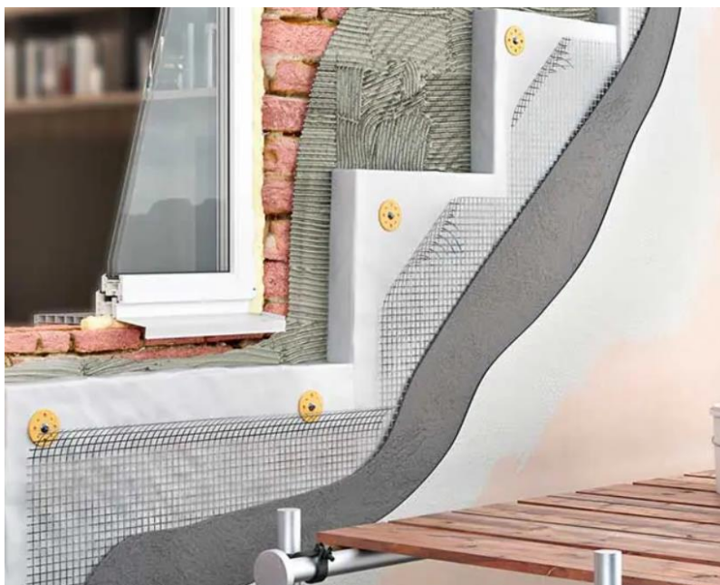
Slika 9. Izolacija vanjskih zidova EPS-om [11]
