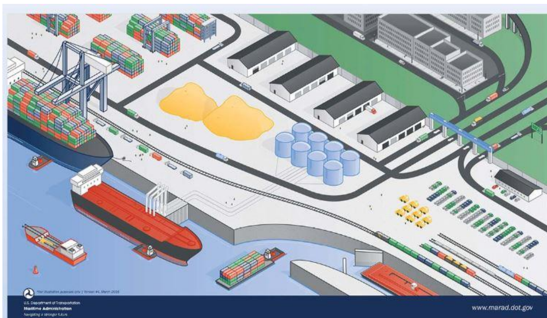
Shema 2. – Shematski prikaz lučke terminalske infrastrukture i suprastrukture.
