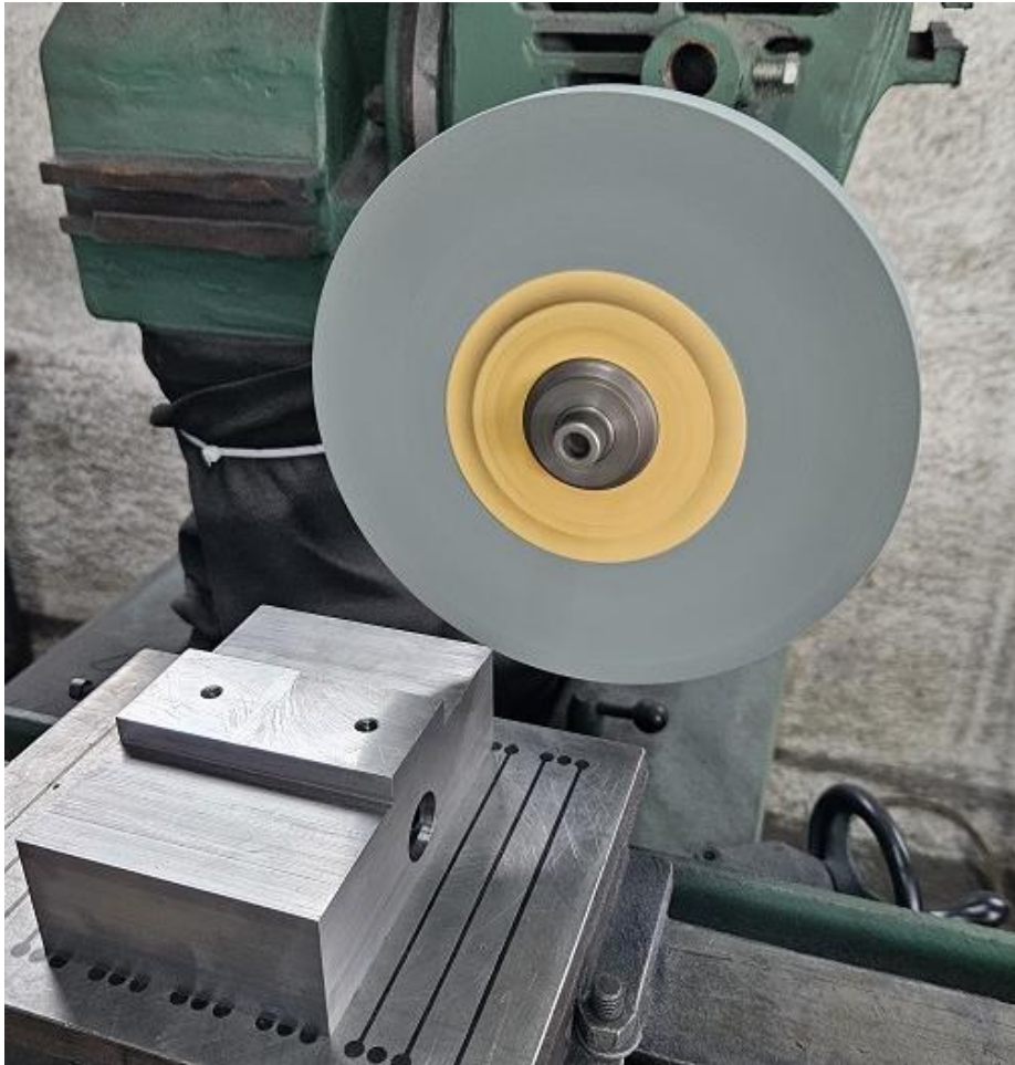
Slika 41: Brušenje donjeg dijela pomične čeljusti[osobne slike]
