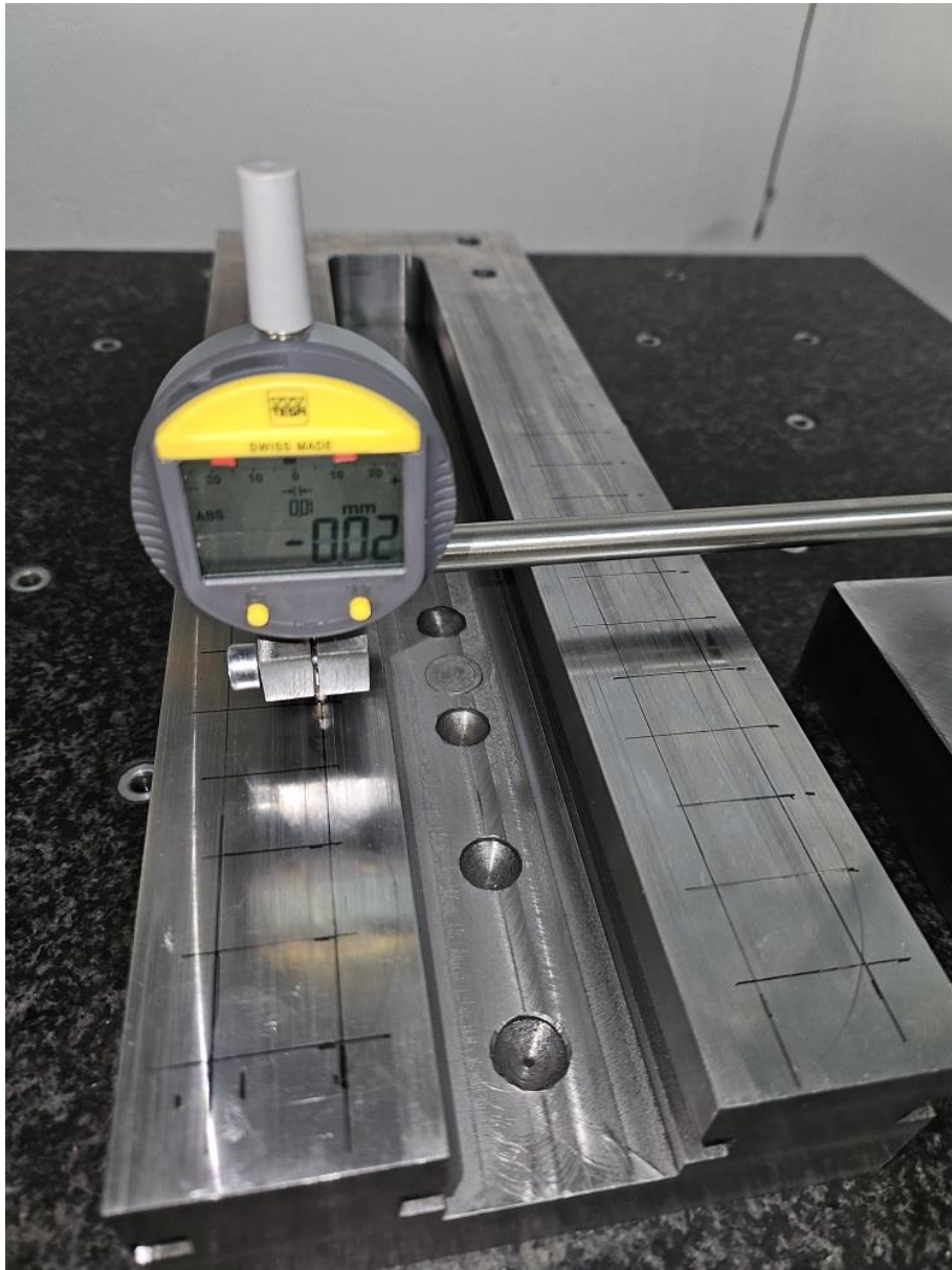
Slika 38: Mreža mjernih točaka [osobne slike]
