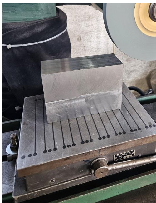
Slika 24: Obradak stegnut na magnetnoj stezaljki [osobne slike]
