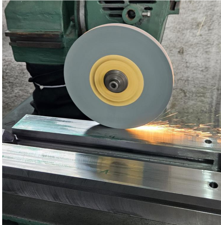
Slika 42: Brušenje baze škripca[osobne slike]
