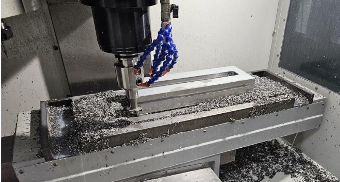
Slika 33: Glodanje sa T glodalom - 2. stezanje [osobne slike]
