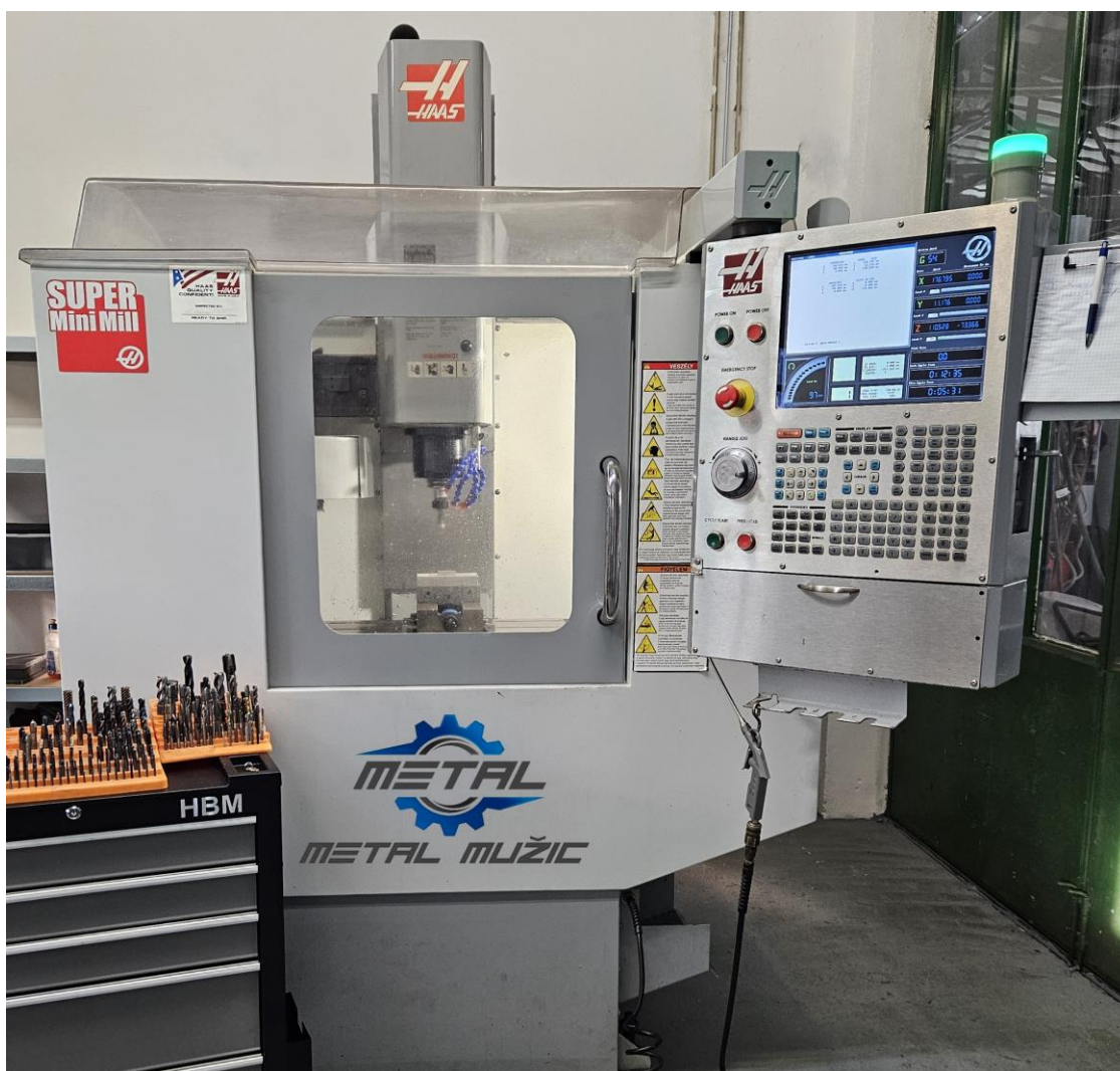
Slika 21: Glodalica koja se koristila za strojnu obradu dijelova u ovom radu[osobne slike]
