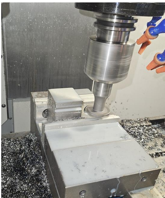
Slika 23: Obradak stegnut u mehanički škripac tijekom glodanja [osobne slike]
