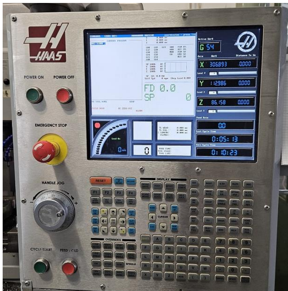
Slika 22: Upravljačka jedinica [osobne slike]
