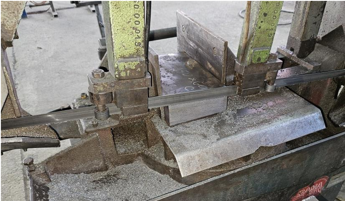
Slika 20: Rezanje sa tračnom pilom [osobne slike]
