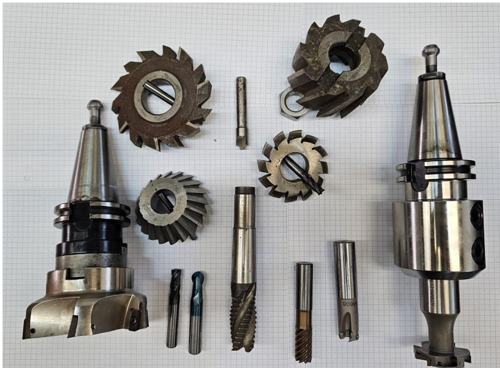
Slika 12. Izvedbe glodala [osobne slike]
