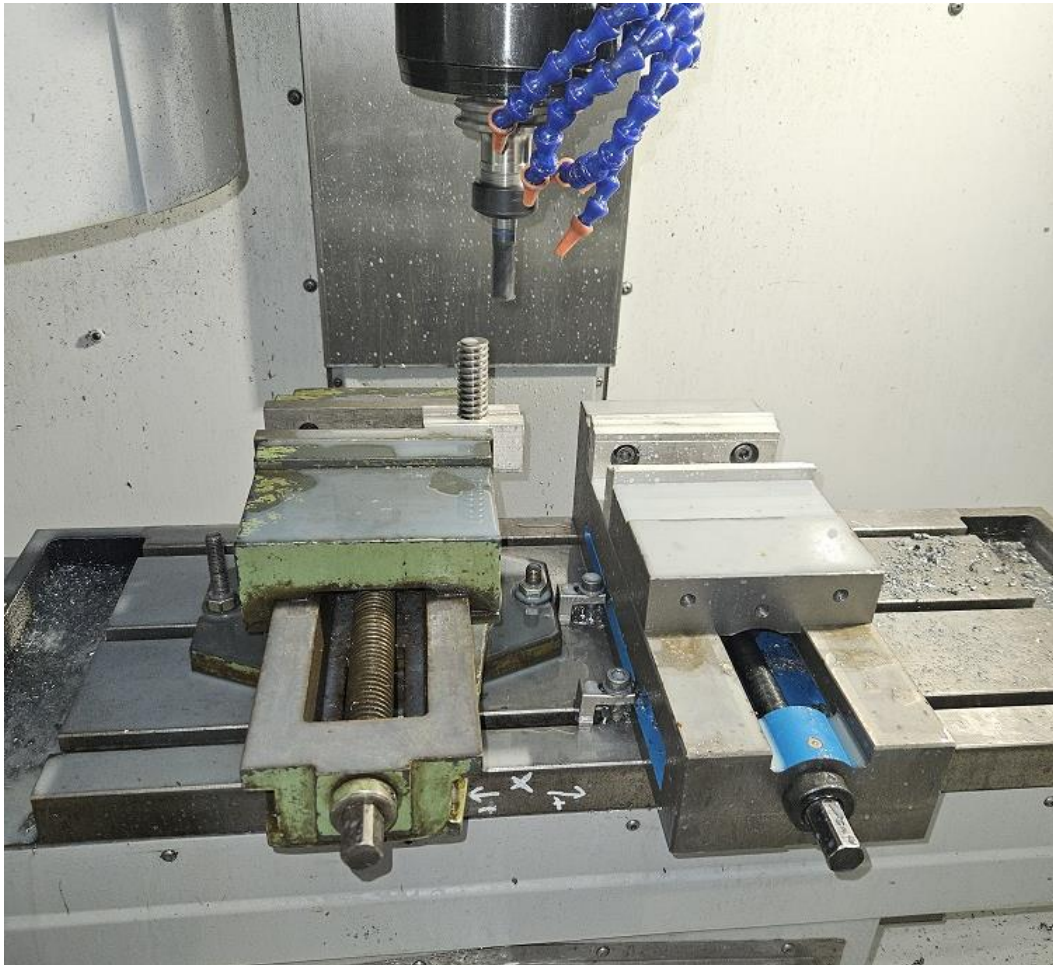
Slika 35: Glodanje šesterokuta na trapeznom navoju[osobne slike]
