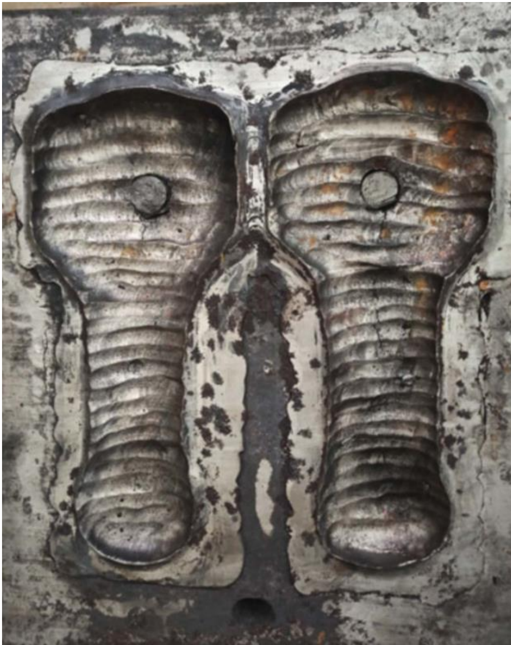
Slika 32 WAAM i reparatura kalupa [34]
