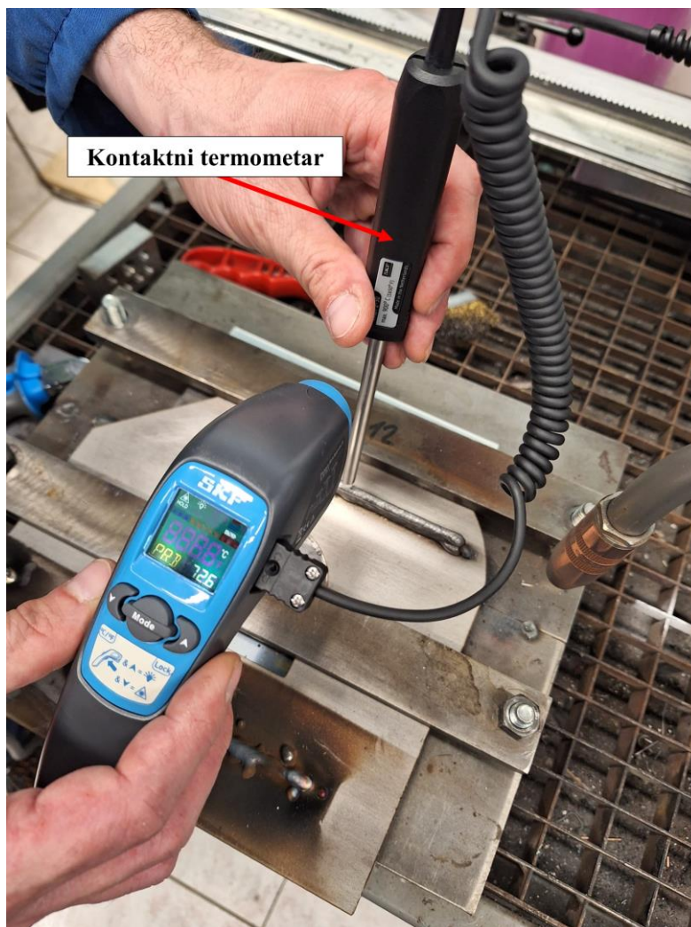
Slika 37 SKF TKTL 20 ThermoLaser
