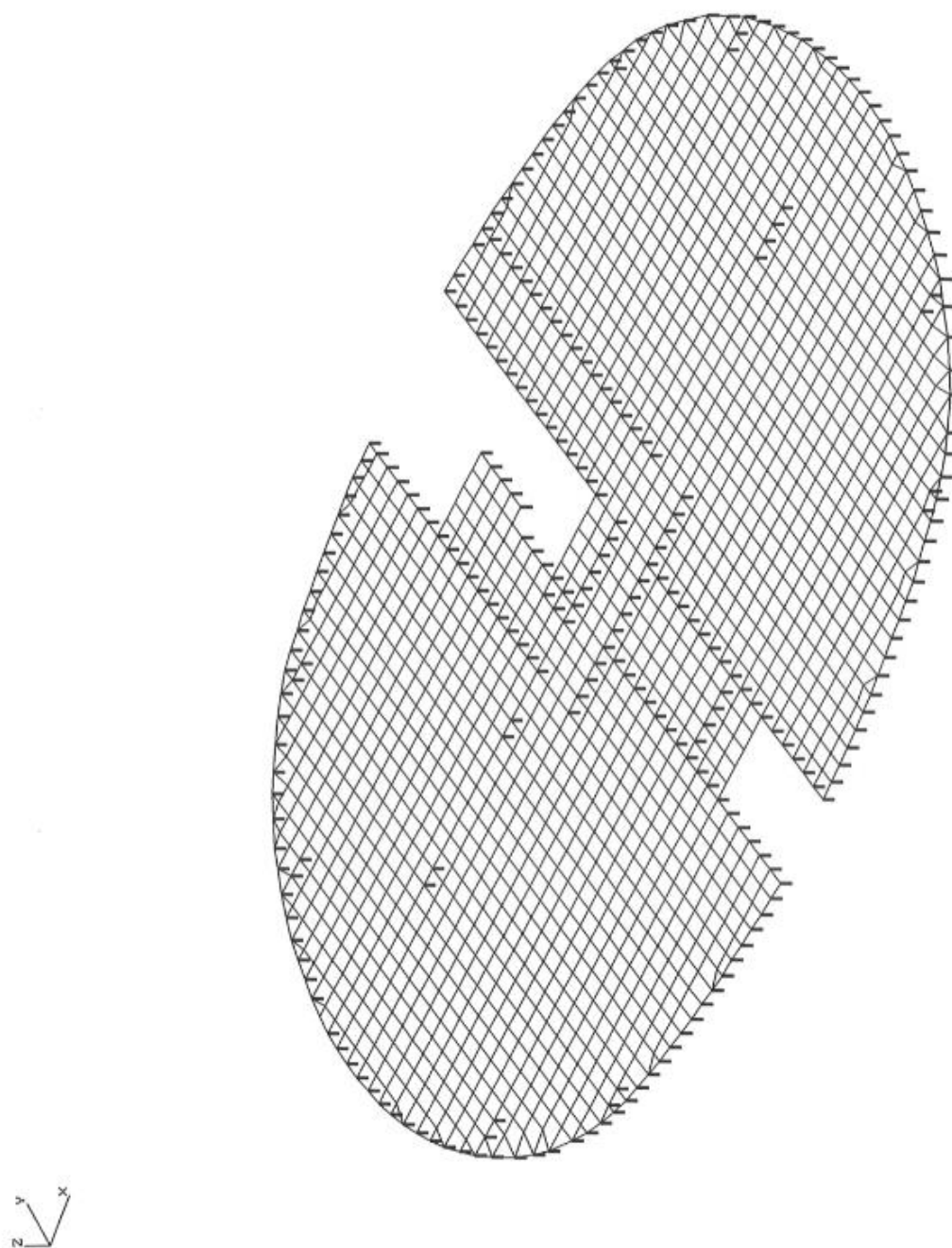
Slika 6.1 Model ploče tipske etaže u varijantnom rješenju klasične ploče debljine 28,0 cm (program GRAFeM) (Izvor: [14])
