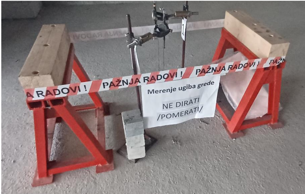
Slika 3.6 Mjerenje progiba grede [Izvor: djelo autora]
