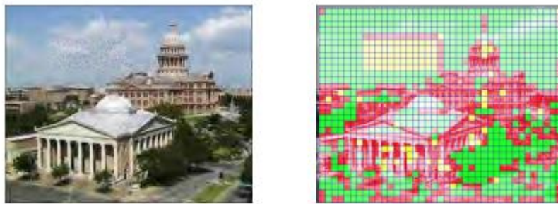
Slika 6.3 JP2K izobličena slika iz LIVE baze podataka s dodatnim AWGN šumom i PIQE prostornom maskom kvalitete. Crveno, žuto i zeleno ispunjeni blokovi označavaju blokove koji zadovoljavaju NDC, NC i uniforme kriterije [27].
