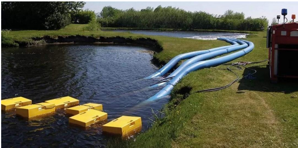
Slika 21: Hytrans FloodModule kao obrana od poplava [18]
