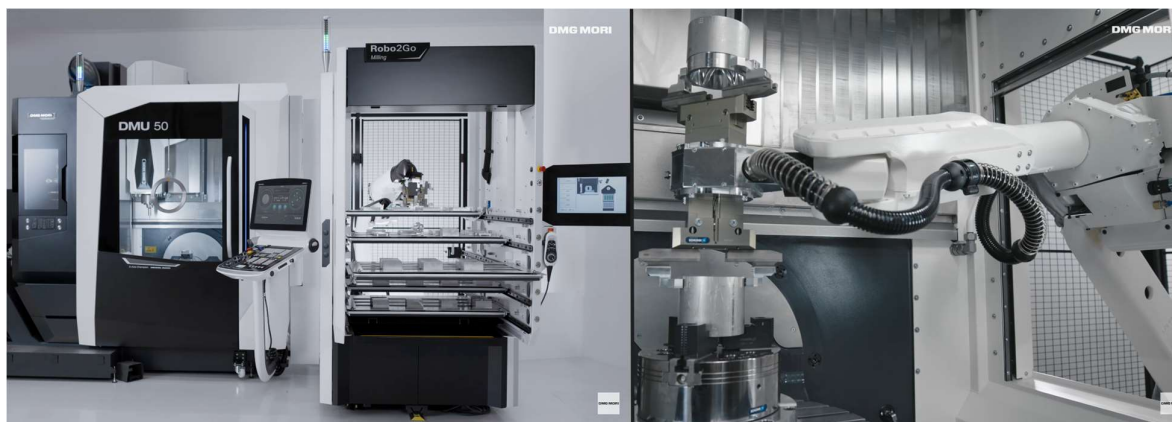
Slika 11. Robotska ruka i ladicama DMG MORI [14]
