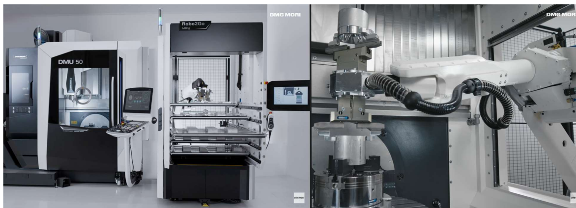
Slika 11. Robotska ruka i ladicama DMG MORI [14]
