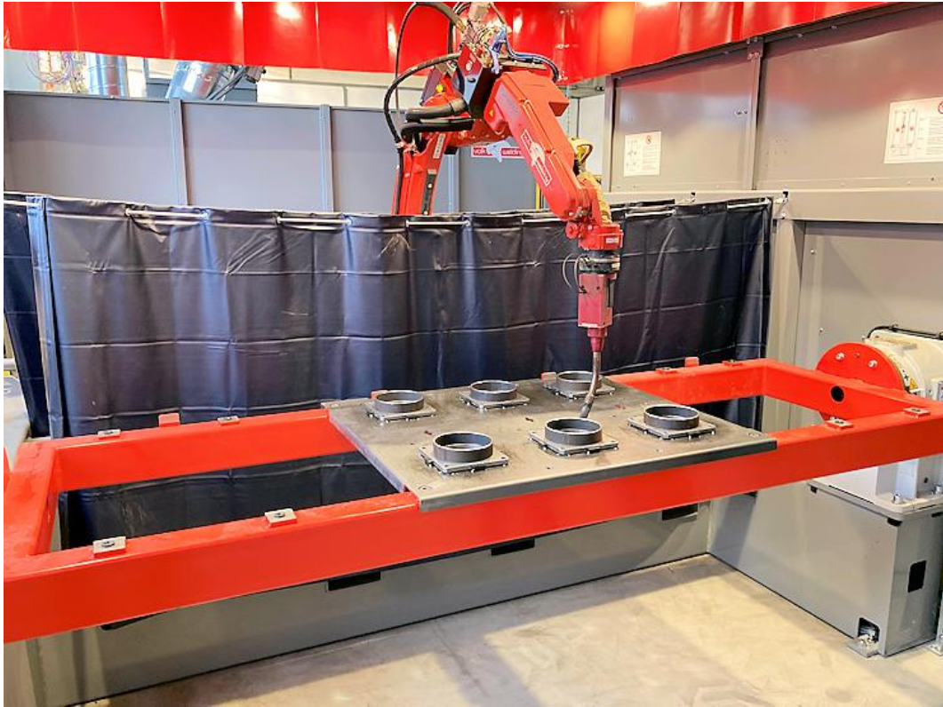
Slika 4.9 Mig zavarivanje pozicija s rotacijskim stolom [19]
