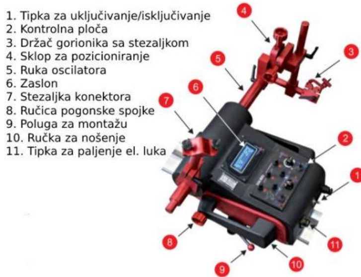
Slika 6.5.1. Dijelovi Rail Bull automata [38]
