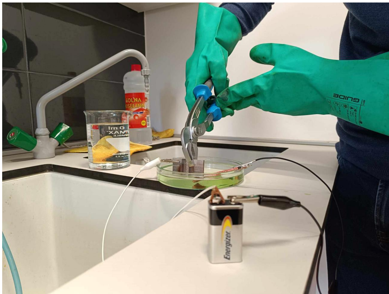
Slika 6.8.5. Elektrokemijsko nagrivanje uzorka
