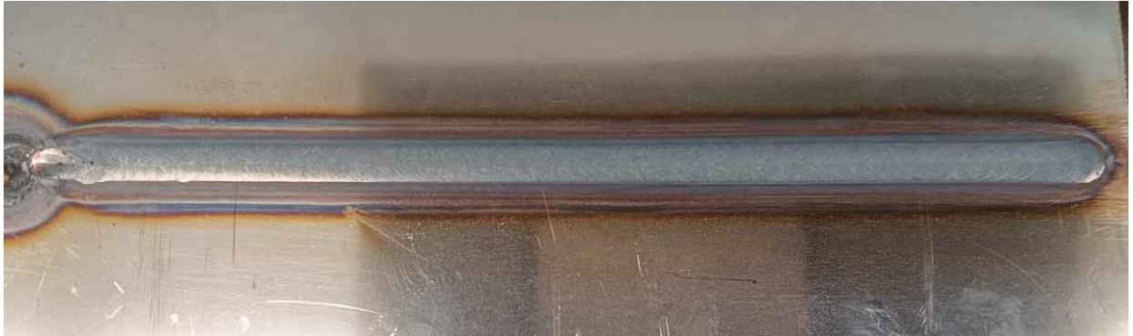
Slika 6.7.1. Lice zavara prvog uzorka
