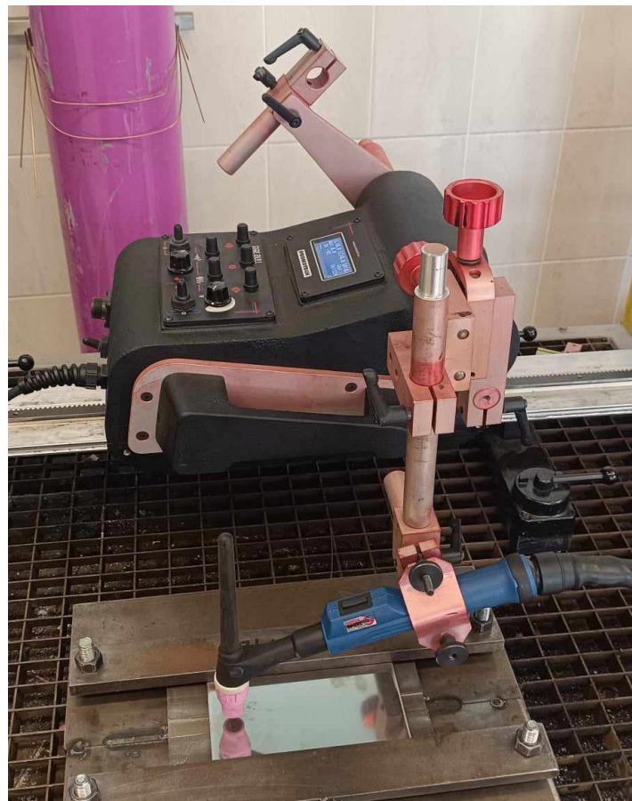
Slika 6.5.2. Rail Bull automat
