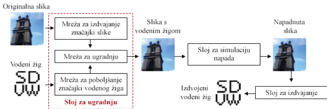
Slike 5.1: Osnovni okvir za postavljanje robusnog vodenog žiga koji se temelji na dubokom učenju. (Izvor: [91])
