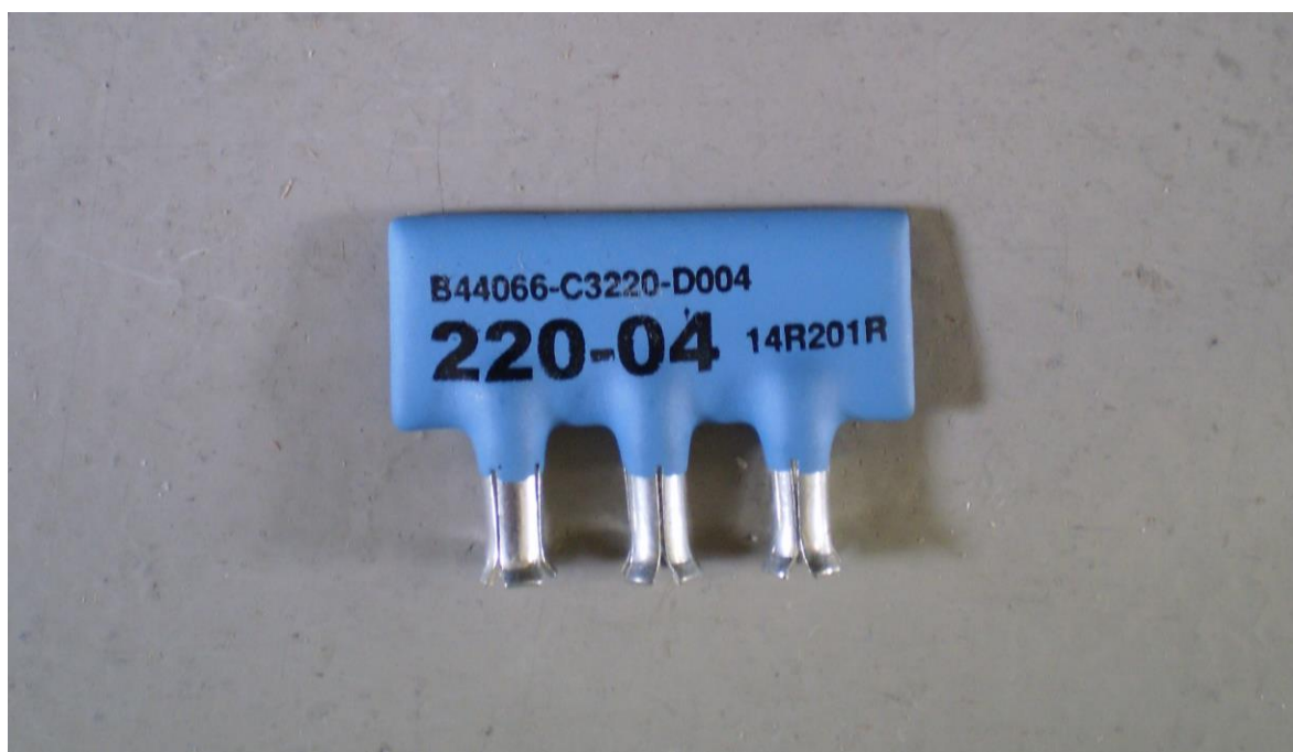
Slika 4.5 Otpornik za pražnjenje kondenzatora
