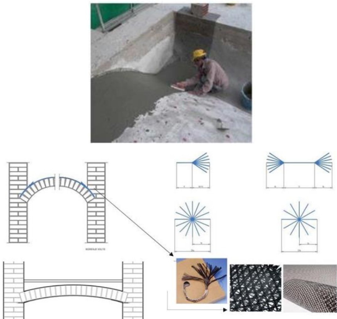
Slika 62: Primjer i prikaz FRCM sustava – prekrivanje kupole [7]
