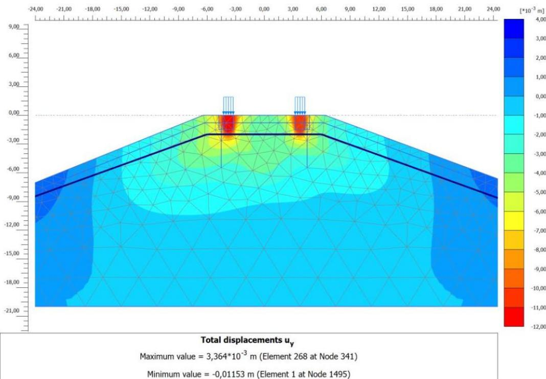
Slika 41: Prikaz vertikalnih pomaka postojeceg stanja [7]
