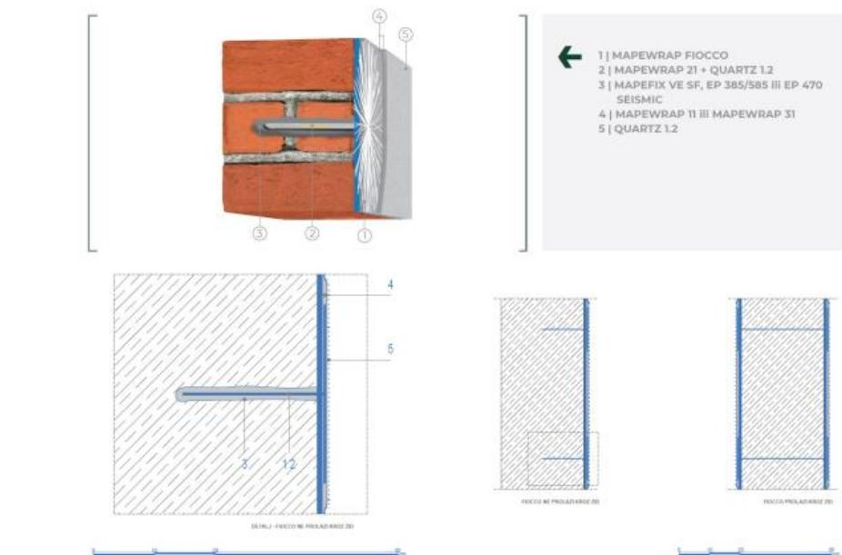
Slika 58: Primjer MAPEWRAP FIOCCO [7]
