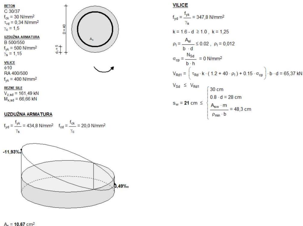
Prema HRN EN 1992-1-1 Najmanji promjer uzdužne šipke ne treba biti manji od 16 mm za bušene pilote te bi njihov broj trebao biti najmanje 6.
