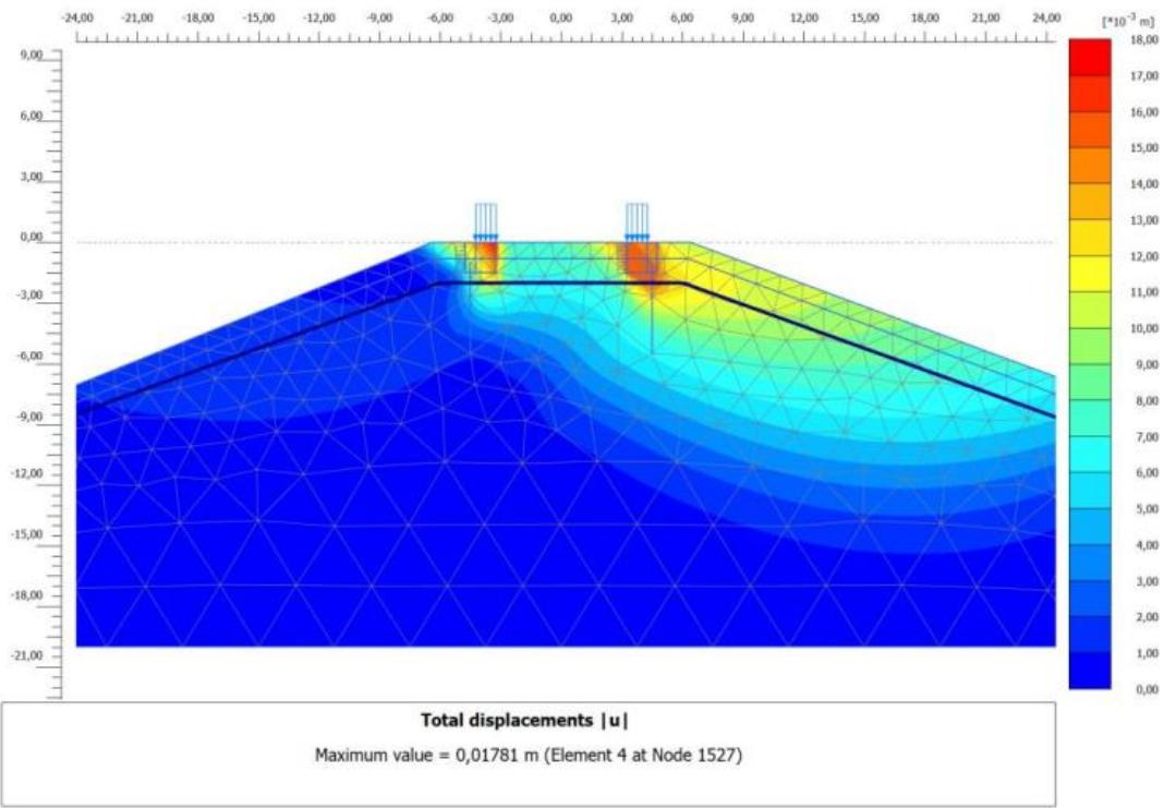
Slika 42: Prikaz ukupnog pomaka bez izvedenih pilota od djelovanja potresnog opterećenja [7]
