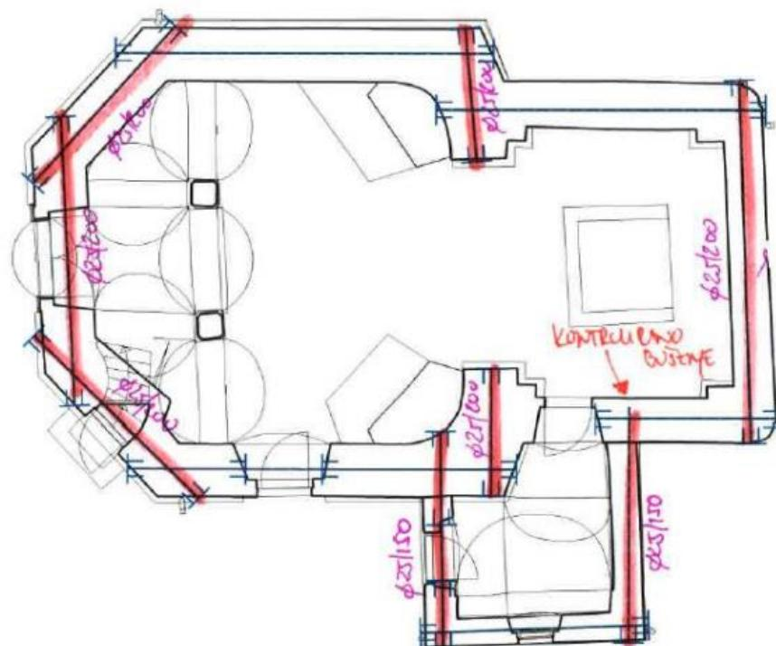
Raspucali zidovi sakristije (zelena boja) dodatno će se ojačati s dodatkom FRCM-a s vanjske strane i unutrašnje strane zidova. Korišteni tip FRCM-a MAPEGRID G220 + mort kao PLANITOP HDM RESTAURO. Moguće je koristiti sustav drugog proizvođača sličnih karakteristika materijala.
