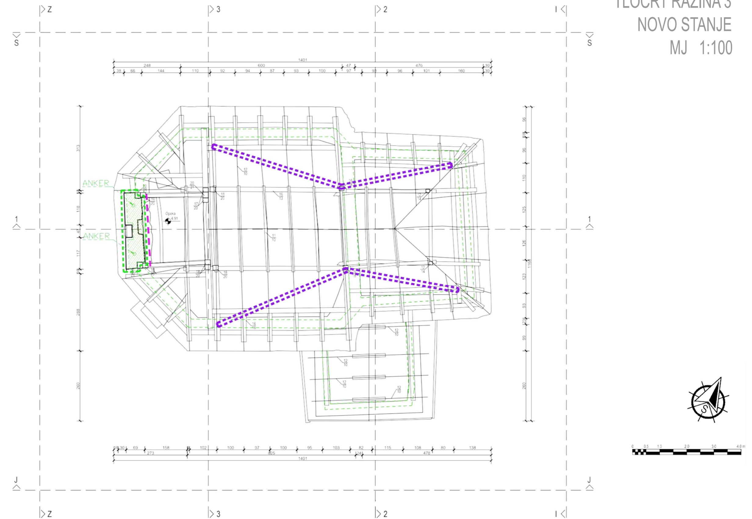
OJAĆANJE POSTOJEĆEG ZIDA - ISPUNJAVANJE STRUKTURE ZIDA + KONTROLIRANO INJEKTIRANJE + ANKERIRANJE - Ø16 + ANKERFIX MORT (KONTROLIRANO INJEKTIRANJE) (POVEZIVANJE ZIDA ANKERIMA)
