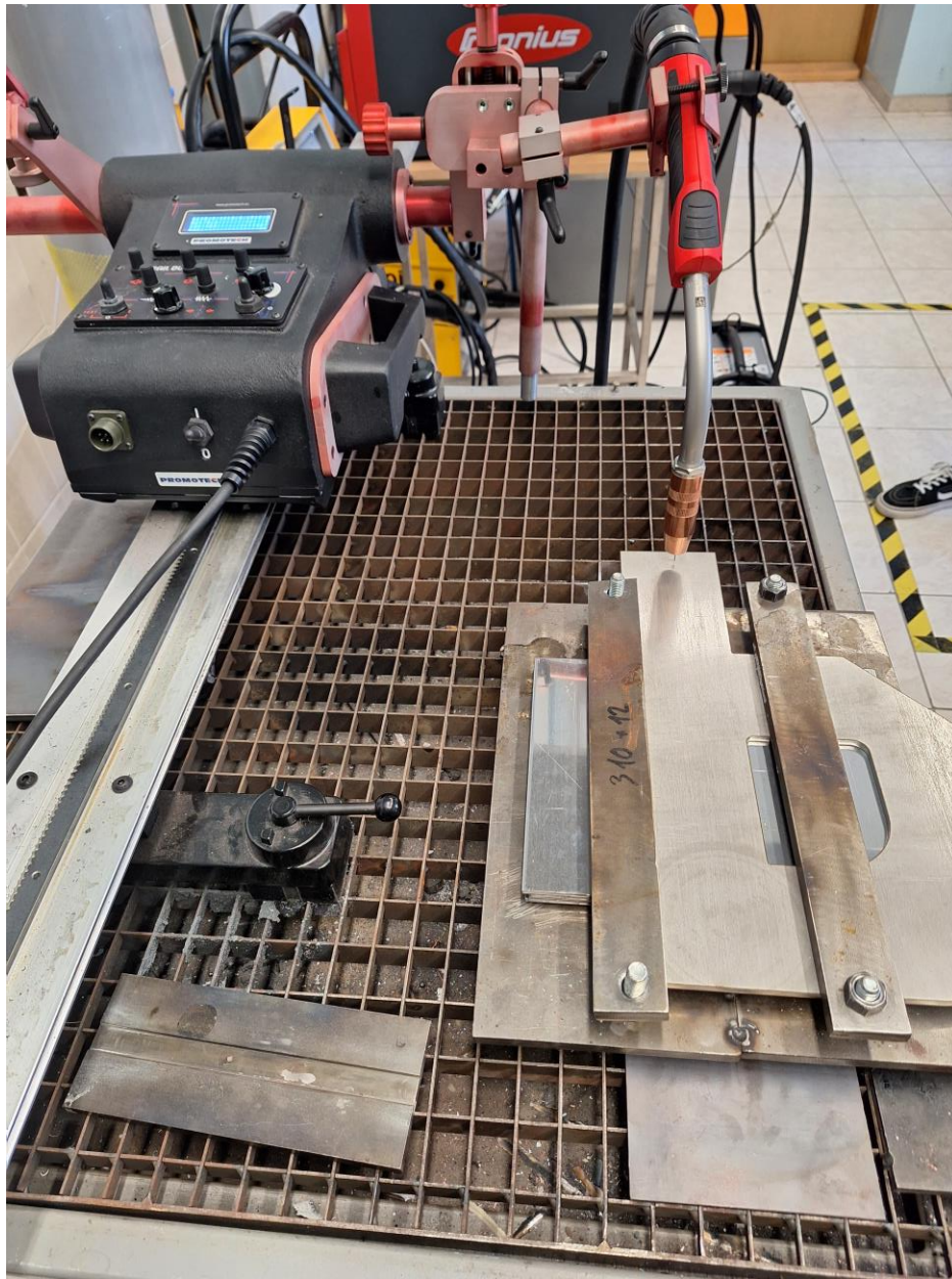
Slika 28: Postavljena podloga za navarivanje, gorionik i uređaj za vođenje
