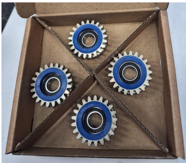
Slika 23: Kotačići za pogon žice
