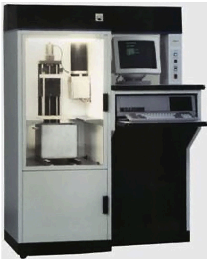
Slika 2. Prvi komercijalni 3D pisač SLA-1
