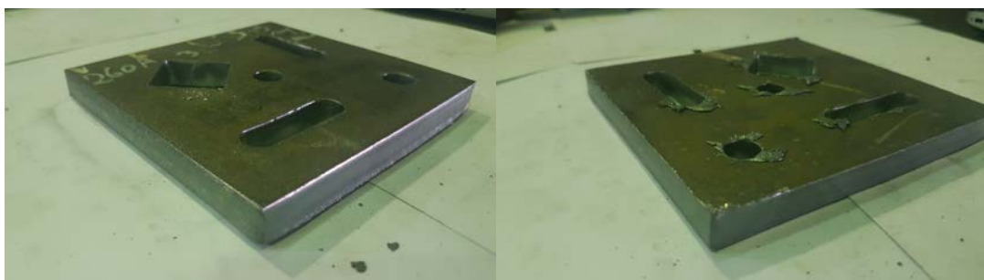
Slika 4.3.37. Uzorak B7.3 debljine 12 mm slikan s gornje i donje strane
