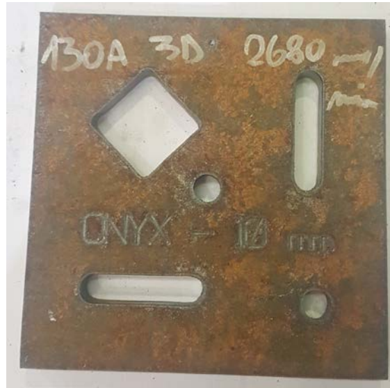
Slika 4.3.30. Uzorak B6.2 debljine 10 mm s podacima o rezanju
