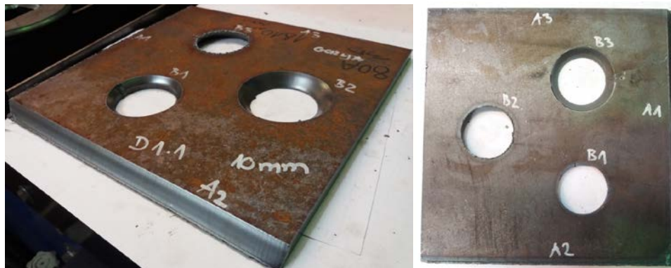
Slika 4.3.67. Uzorak D1.1 debljine 10 mm slikan s gornje i donje strane s oznakama
