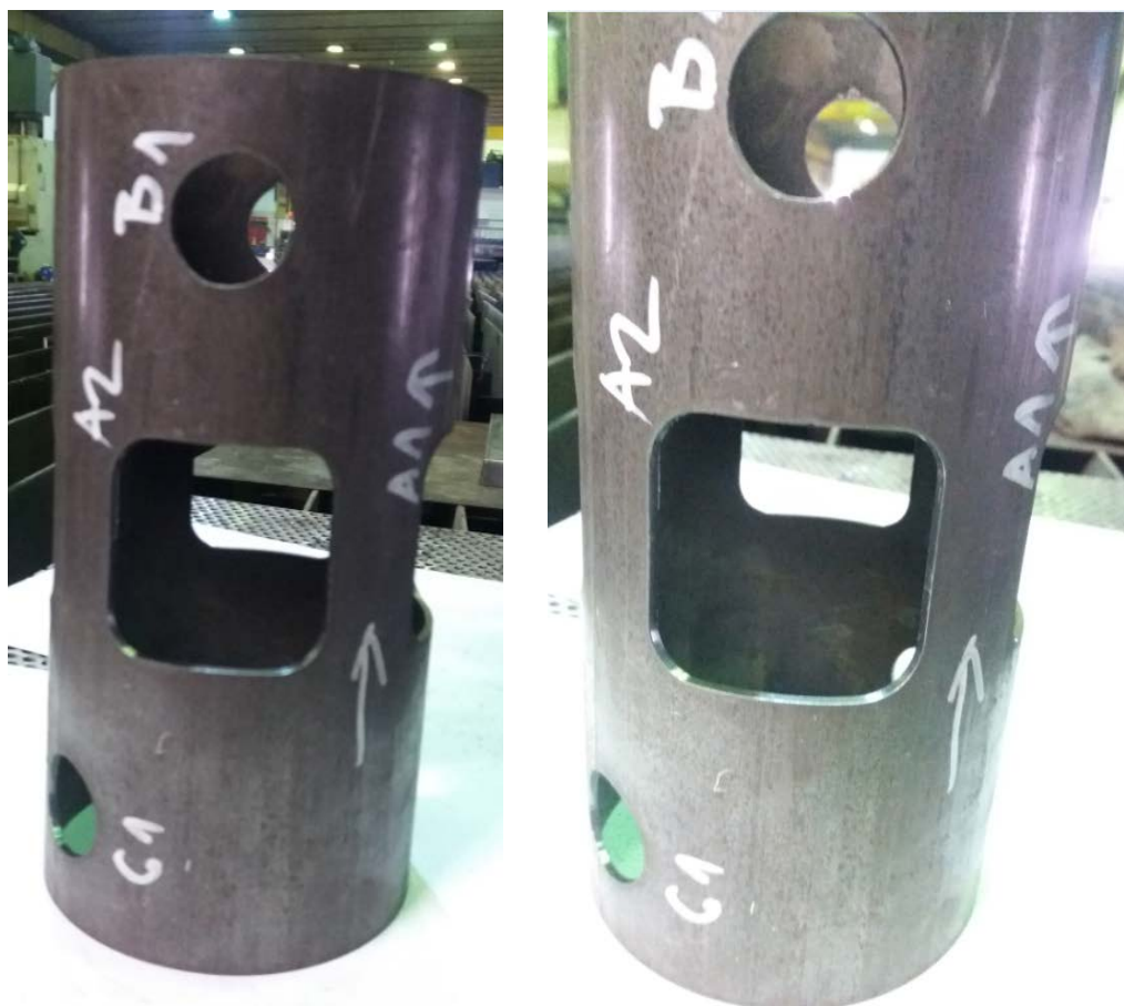
Slika 4.3.76. Uzorak E2.1 cijevi debljine stijenke 2 mm s oznakama
