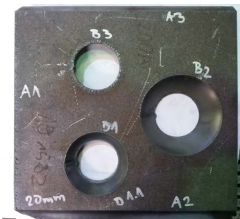
Slika 4.3.70. Uzorak D3.1 debljine 20 mm s podacima o rezanju i oznakama
