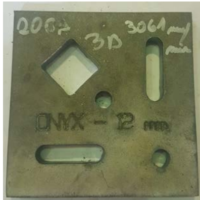
Slika 4.3.34. Uzorak B7.2 debljine 12 mm s podacima o rezanju
