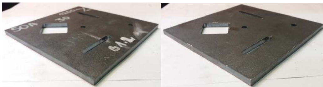
Slika 4.3.17. Uzorak B3.2 debljine 5 mm slika s gornje i donje strane
