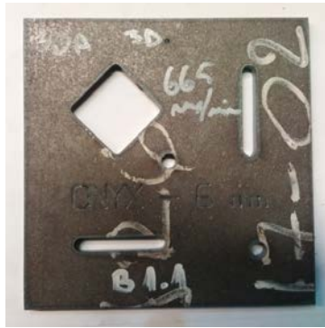
Slika 4.3.18. Uzorak B4.1 debljine 6 mm s podacima o rezanju
