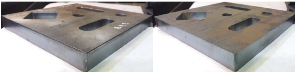
Slika 4.3.51. Uzorak B9.3 debljine 25 mm slikan s gornje i donje strane
