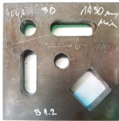
Slika 4.3.54. Uzorak B10.2 debljine 30 mm s podacima o rezanju
