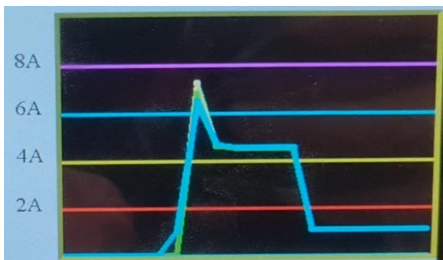
Slika 6.12 – Mjerenje PLC-om kod pokretanja spojem zvijezda-trokut
