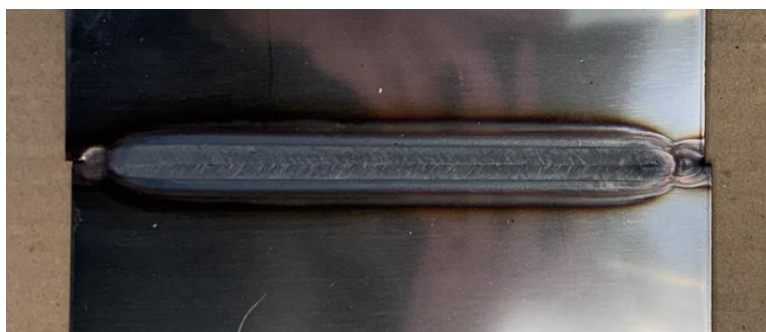
Slika 28. Lice zavara uzorka 1
