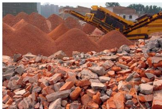
Slika 38. Otpad od glinene opeke, obrada agregata [15]
