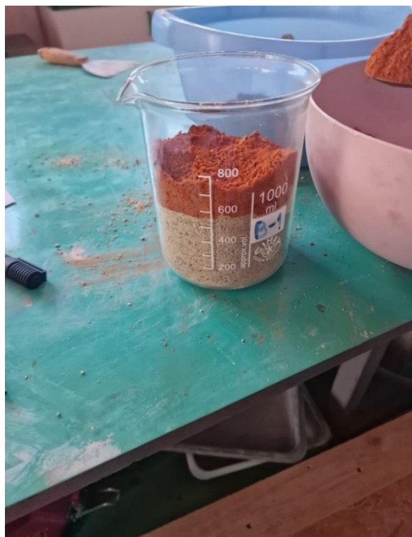
Slika 45. Prosijani agregat ( pijesak i drobljena opeka )
