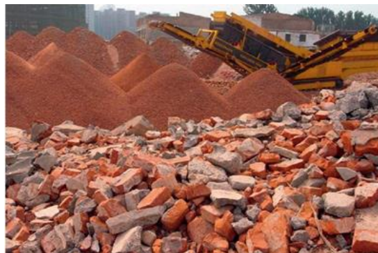
Slika 38. Otpad od glinene opeke, obrada agregata [15]
