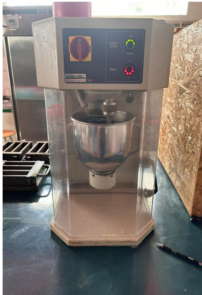
Slika 48. Miješalica za izradu mješavina morta
