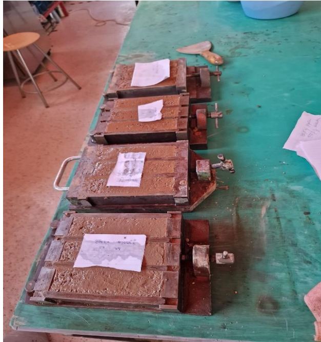
Slika 51. Mješavine morta ugrađene u kalupe
