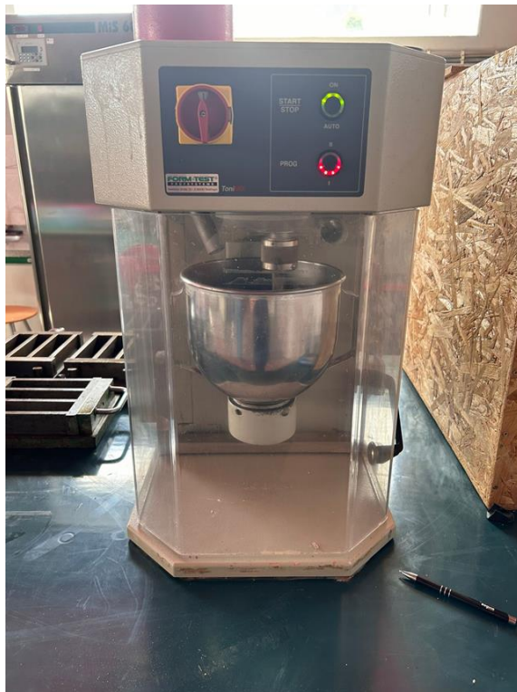
Slika 38. Miješalica za izradu mješavina morta
