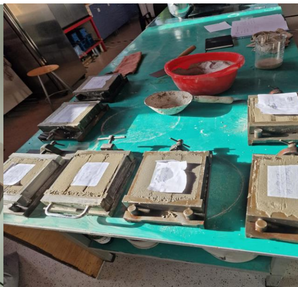
Slika 41. Mješavine morta ugrađene u kalupe
