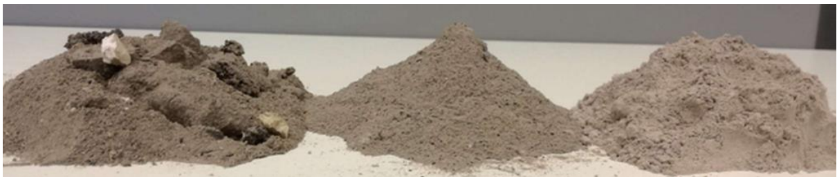
Slika 4. Uzorci pepela drvene biomase: a) pepeo s dna peći; b) leteći pepeo krupnije frakcije; c) finiji leteći pepeo [6]
