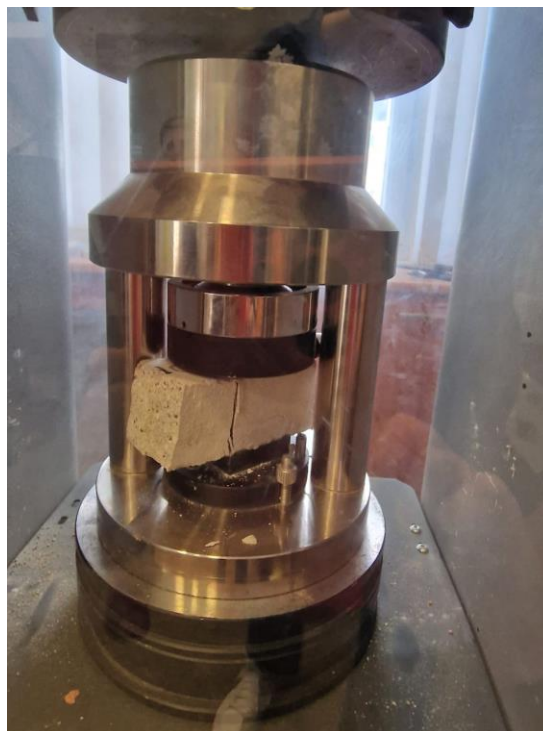
Slika 31. Određivanje tlačne čvrstoće prizmica sa kvarcnim pijeskom
