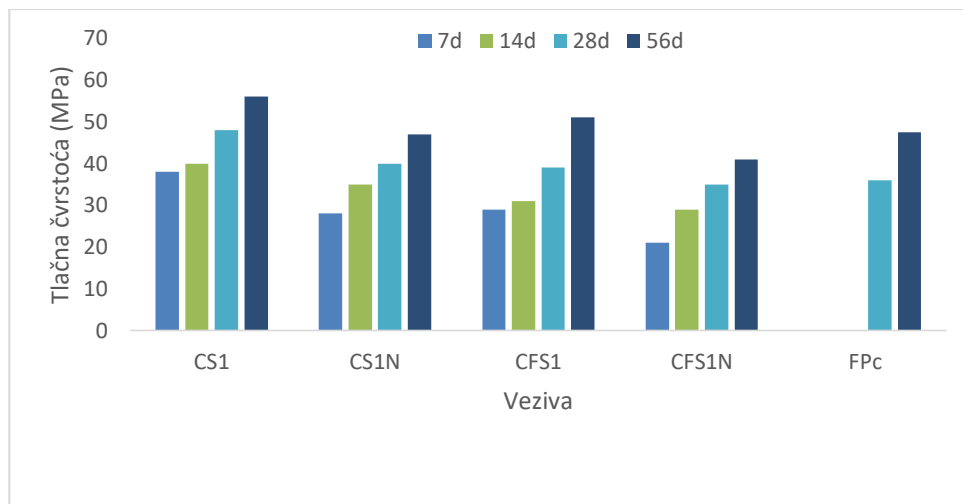
Slika 22. Tlačna čvrstoća geopolimernog veziva u vremenu: utjecaj alkalnog aktivatora 1 [14]
