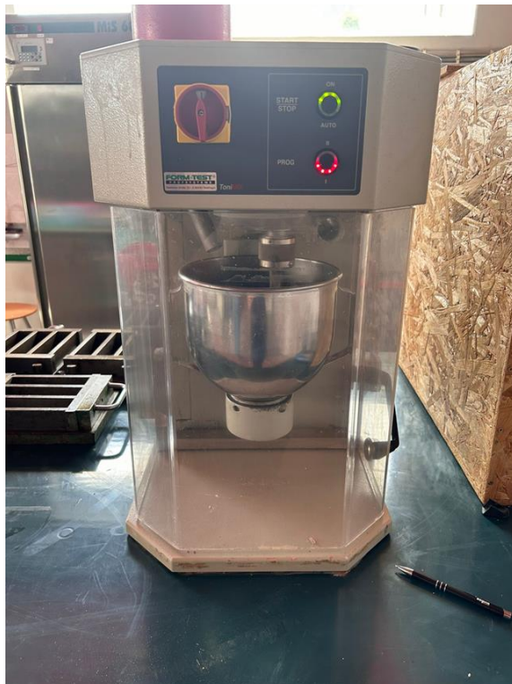
Slika 38. Miješalica za izradu mješavina morta
