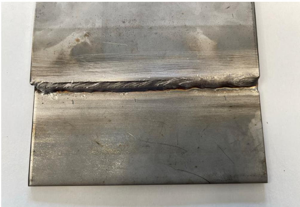
Slika 39. Očišćeni komad nakon zavarivanja [28]
