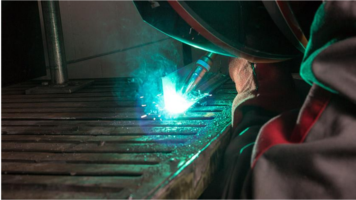
Slika 14. Proces MIG/MAG zavarivanja u praksi [3]
