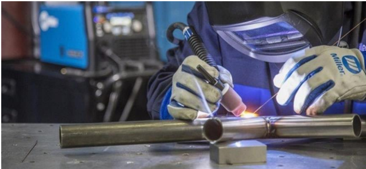
Slika 7. TIG zavarivanje cijevi od nehrđajućeg čelika [23]
