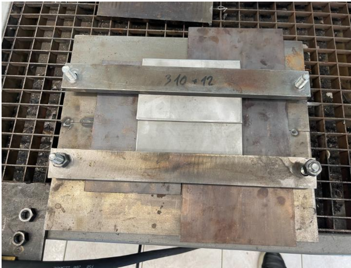
Slika 33. Prikaz pozicioniranog ispitnog uzorka spremnog za zavarivanje [28]
