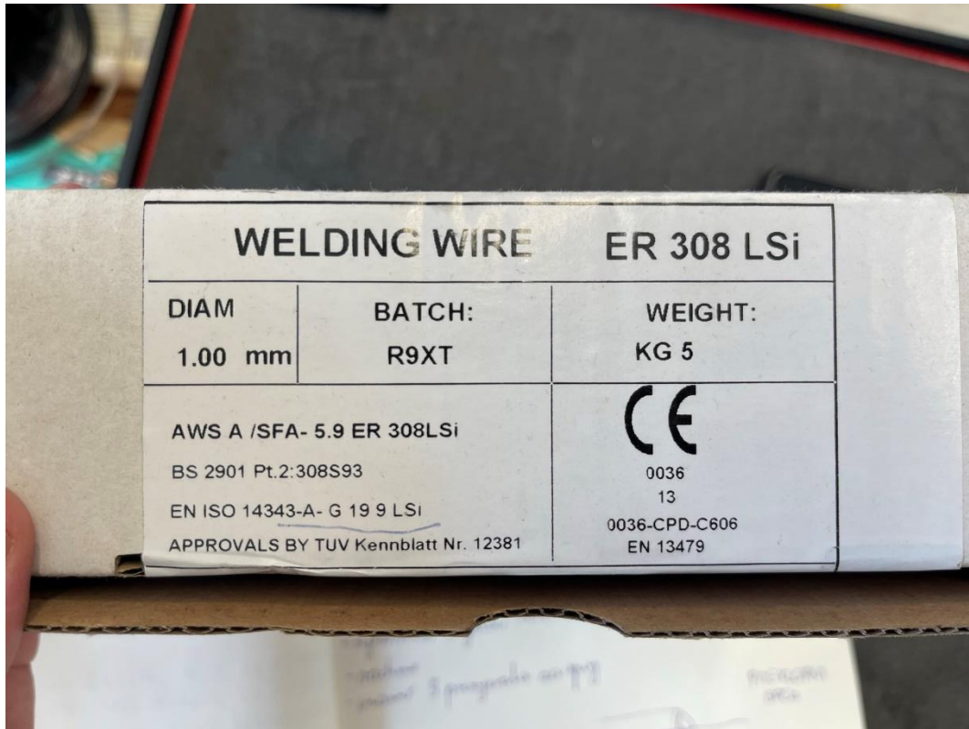
Slika 27. Žica za zavarivanje EN ISO 14343-A-G 19 9 LSi [28]
