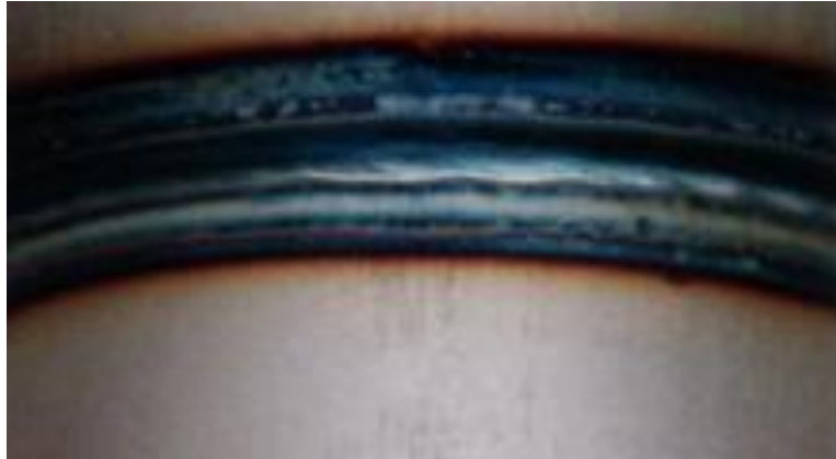
Slika 24. Oksidacija uz zavar [20]
