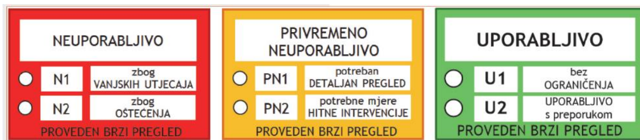
Slika 11. Razine oštećenja koje su utvrđivane brzim pregledima
