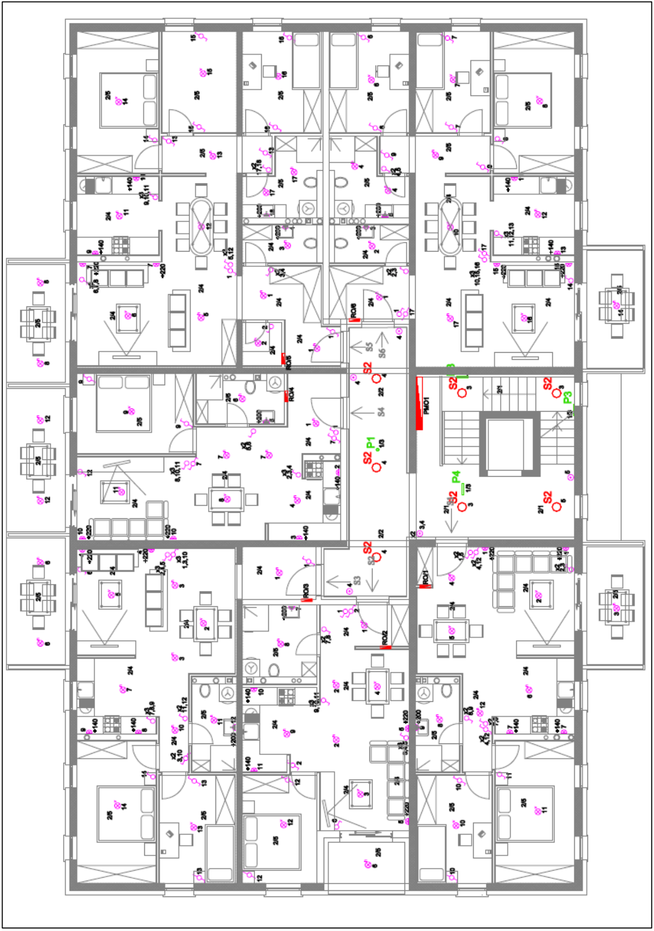
Prilog 3 Tlocrt kata s električnom instalacijom rasvjete [2]
