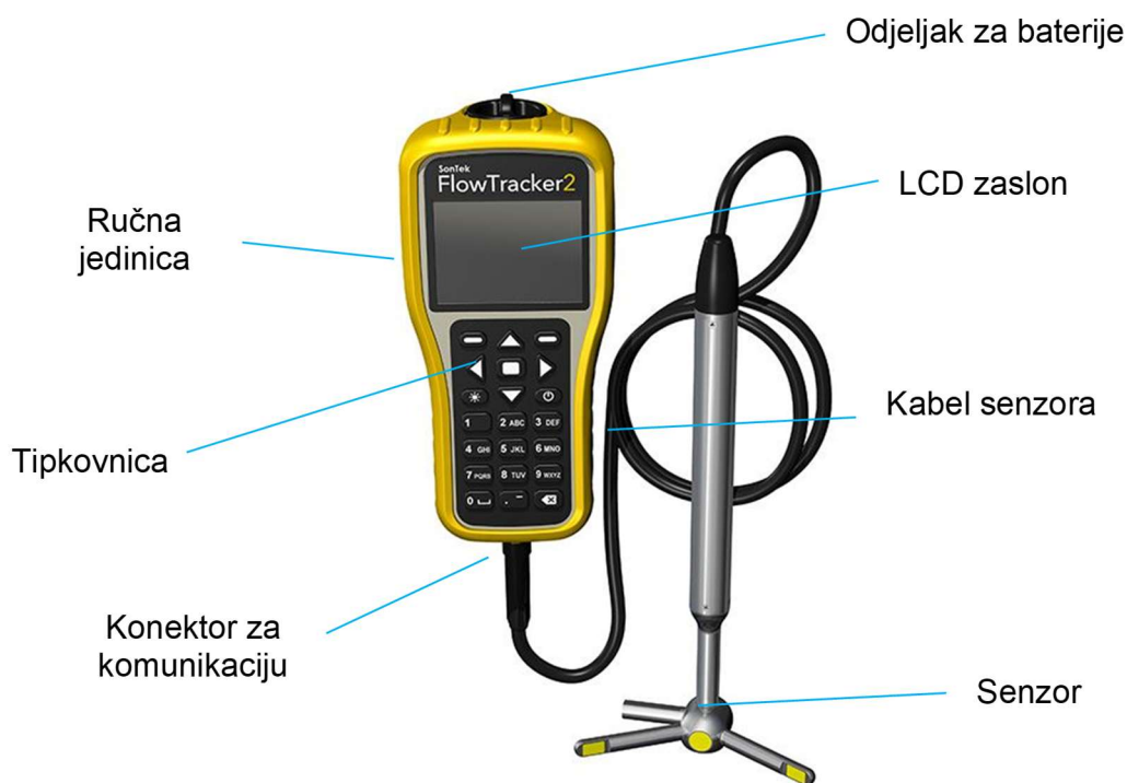
Slika 4.7 FlowTracker2 – glavne komponente [35]
