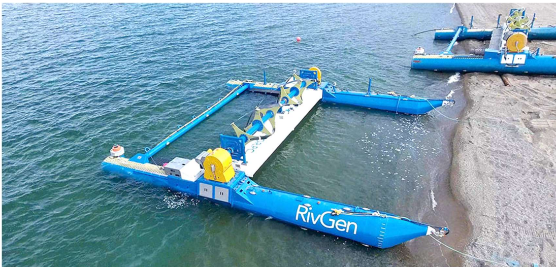
Slika 2.31 RivGen podvodna spiralna turbina [25]
