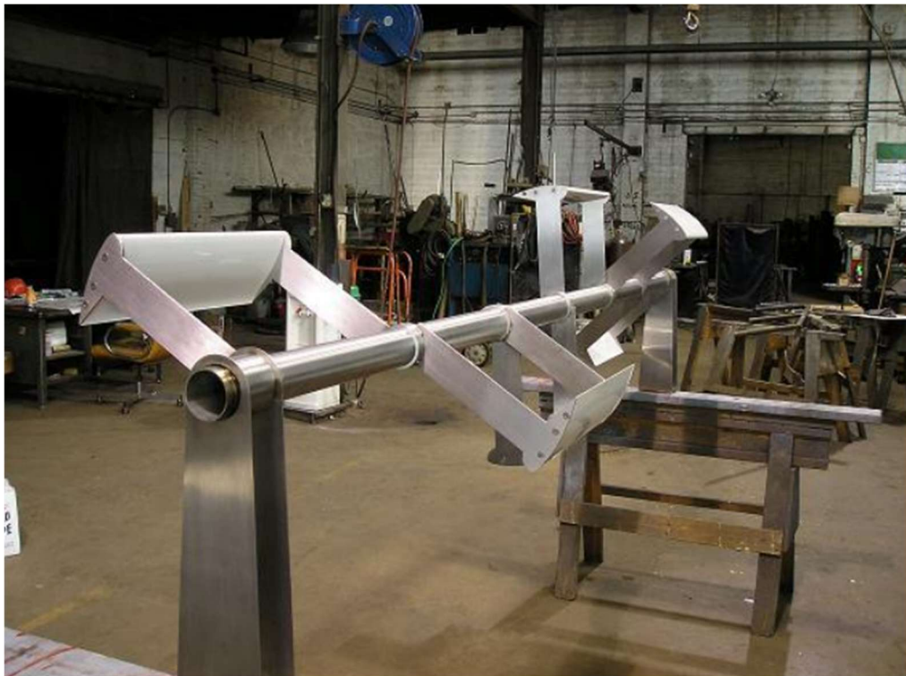
Slika 2.12 Prikaz kinetičke turbine na horizontalnom vratilu [11]
