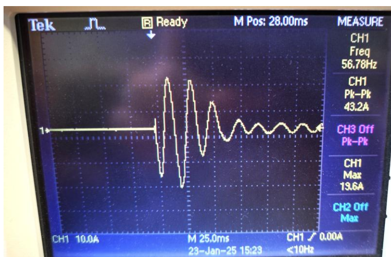
Slika 5.4 Osciloskopski prikaz struje zaleta kod direktnog pokretanja
