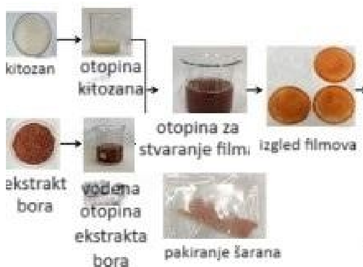
Slika 14 Izrada i izgled filmova na bazi kitozana za pakiranje odrezaka šarana [44]
