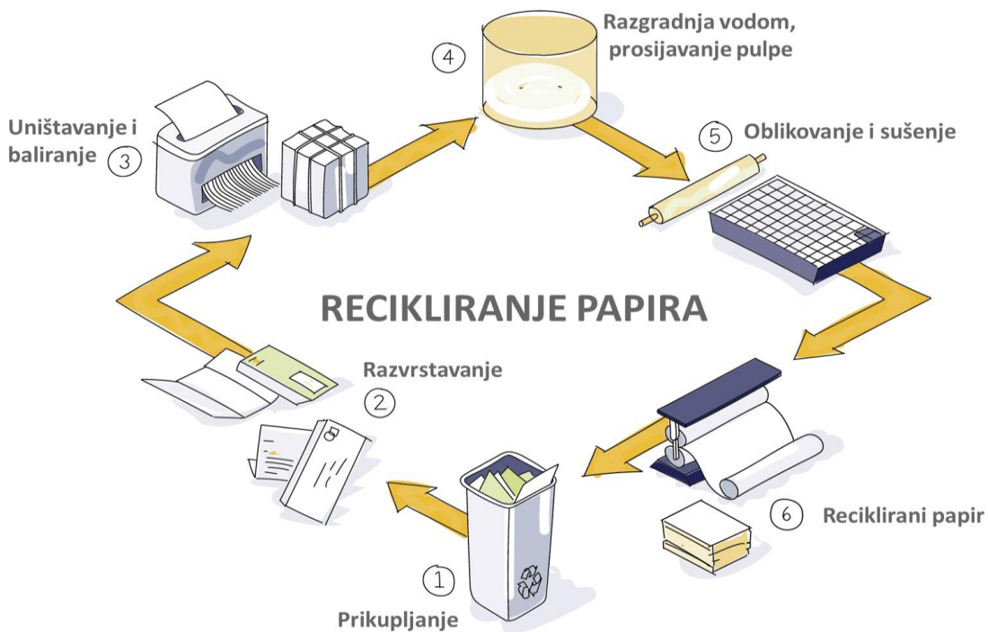
Slika 14. Shema procesa recikliranja papira, odnosno kartona [43]
