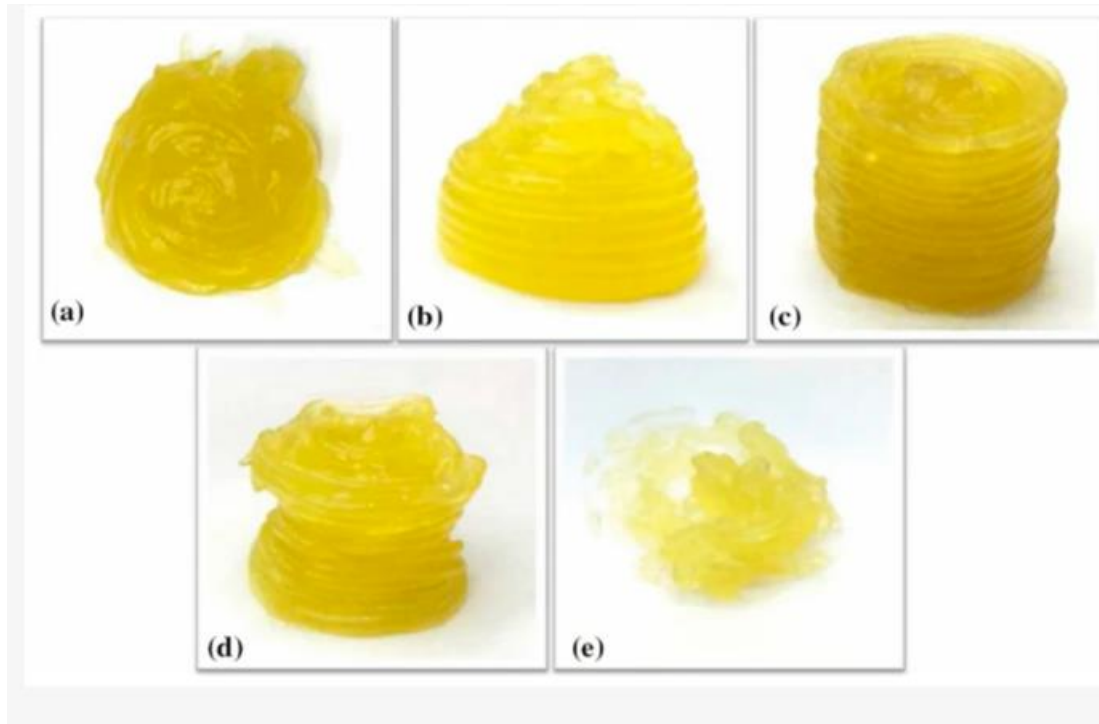
Slika 2.6. 3D tiskani gel od soka limuna s različitim udjelima krumpirovog škroba (a) 10% škroba; (b) 12.5% škroba; (c) 15% škroba; (d) 17.5% škroba; (e) 20% škroba [58]
