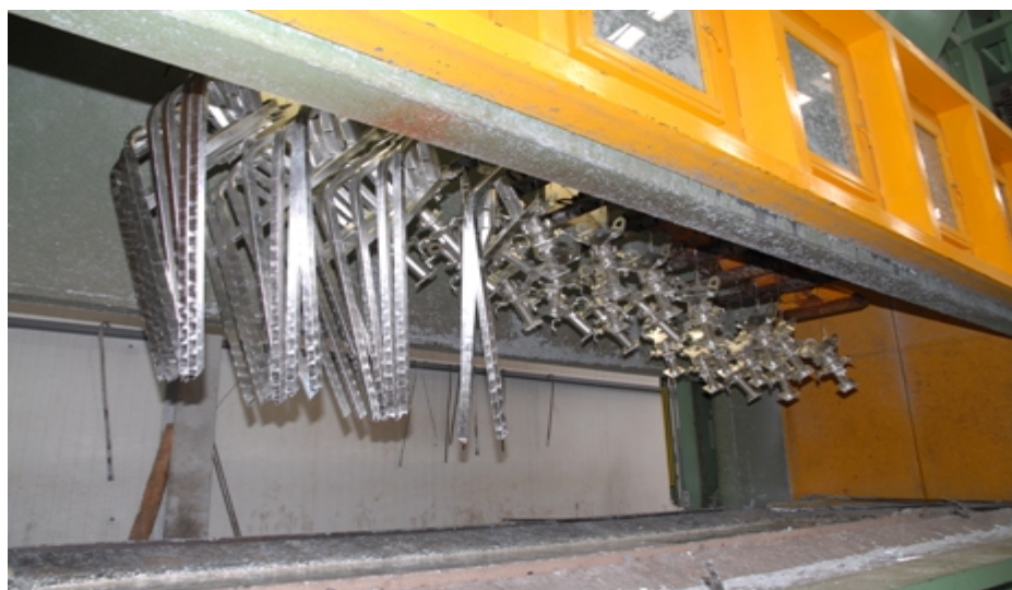
Slika 1.1 Primjer vruće pocinčane komponente, „OMEGA“ [3]
